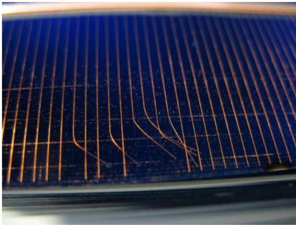
Bild 7: Sich lösende Kupfer Galvanik Finger
