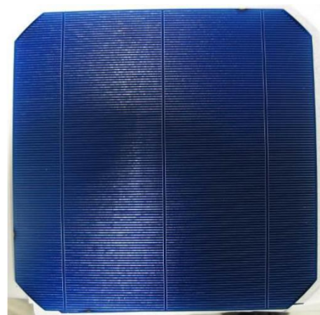
Bild 6: Galvanik Zelle mit zwei „Finger Busbar“
