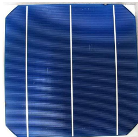
Bild 4: Galvanik Zelle 156 x 156 mm 2
