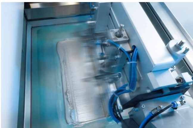
Bild 30: Siebdruck des elektrisch leitfähigen Klebstoffes
