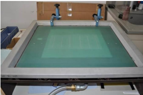
Bild 14: Siebdruckvorrichtung zur Auftragung
