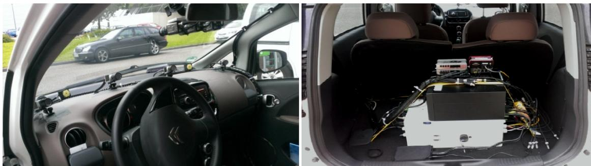
**Abbildung 1: Versuchsaufbau mit Eyetracking-System und Messbox**
