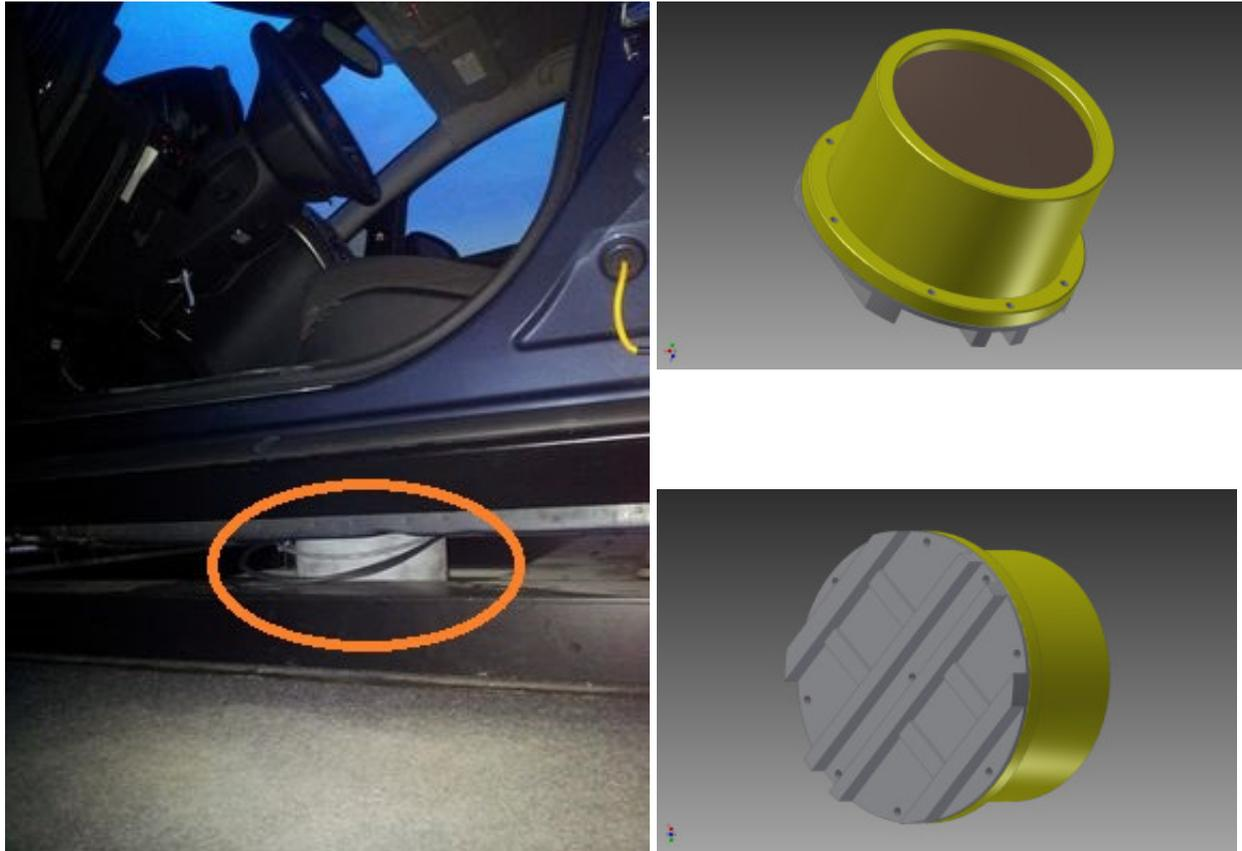
**Abbildung 13: Schwingerreger Fahrzeugunterboden im eingebauten Zustand und CAD-Konstruktion mit Trägerplatte und Gleitlager**
