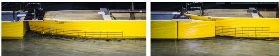
Abb. 7.14: M2030B Koppelverband ohne (links) und mit (rechts) Füllstück
