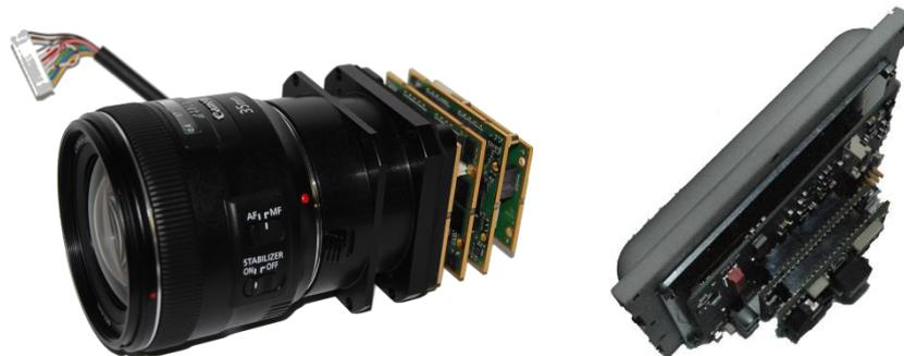
**Abb. 8: Stacksystem mit CMOS- und Radar-Frontend (rechts).**
