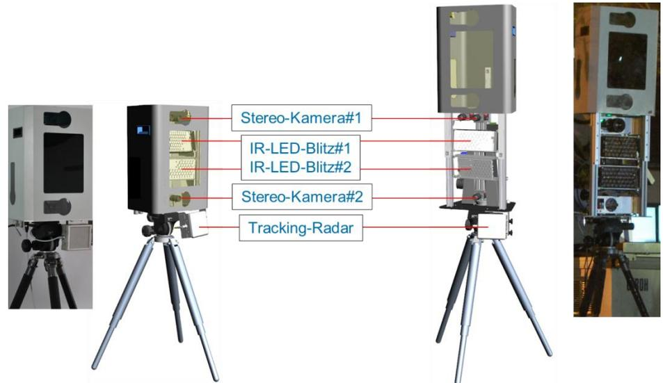
**Abb. 12: OLPOMETS-Messsystem im Demonstratorgehäuse mit geschlossener und offener Ausführung.**
