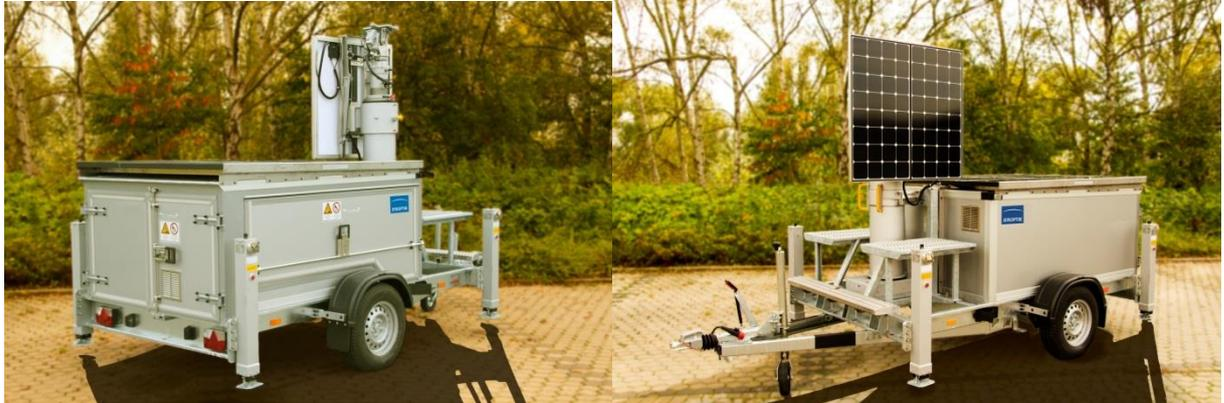
**Abb. 6: Semi-mobiler OLPOMETS-Demonstrator-Anhänger zur Aufnahme des Messsystems mit Energieversorgung inkl. Solarzellen zur Erhöhung der Betriebslaufzeit.**
