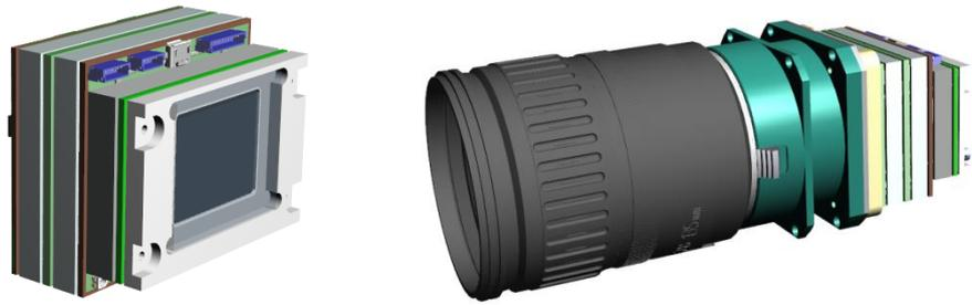
**Abb. 7: Modell des Stacksystems ohne Sensorboard sowie mit CMOS-Frontend (rechts).**
