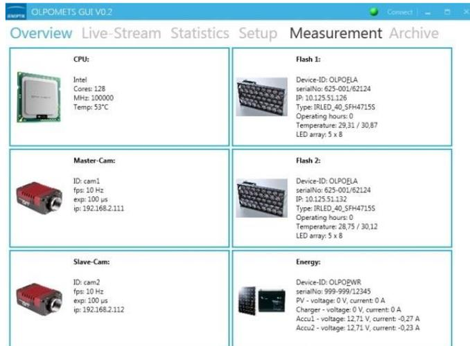
**Abb. 11: OLPOMETS-Benutzerschnittstelle (GUI) mit Statusanzeige der Hardware-Komponenten.**
