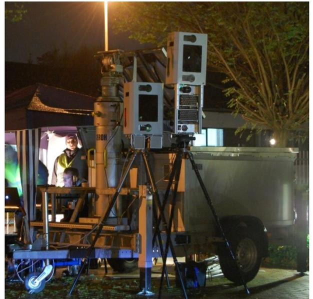
**Abb. 21: Test des OLPOMETS-Demonstrators am Messplatz Hildesheim-Lerchenkamp bei ankommendem Verkehr (links); Vergleichende Messungen zwischen Referenzkomponenten und dem OLPOMETS-Demonstrator auf dem Firmenparkplatz der Jenoptik Robot GmbH in Hildesheim (rechts)**
