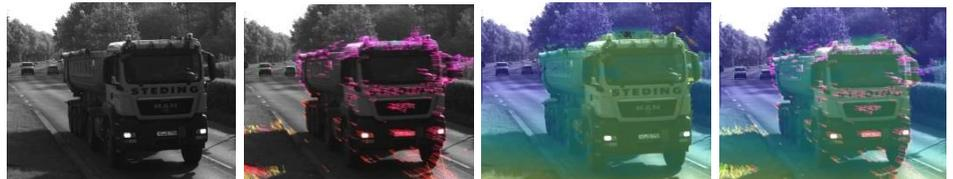
**Abb. 10: Prozesskette der Bildverarbeitung zur Geschwindigkeitsermittlung: Rohbild, Optischer Fluss, Disparitätenschätzung, kombinierte Ansicht des optischen Flusses mit Disparitätenschätzung, 3D-Tracking.**
