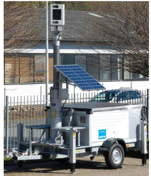
**Abb. 13: Semi-mobiler OLPOMETS-Demonstrator-Anhänger zur Aufnahme des Messsystems mit Energieversorgung inkl. Solarzellen zur Erhöhung der Betriebslaufzeit.**
