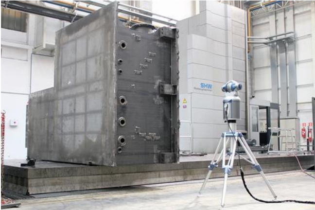
Abb. 44: 3d-Lasertracker (Quelle FARO)
