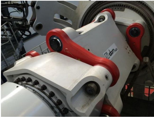
Abb. 20: Ausgleichskupplung zwischen Antriebsmotor und Momentenlager
