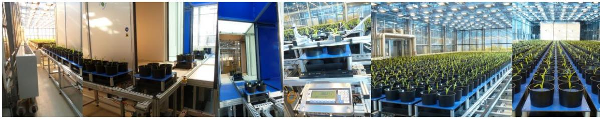
Abbildung 1: Phänotypisierung der 198 Maiszuchtlinien in 2 Blöcken mit je 4 Replikaten in automatisierten Phänotypisierungsanlage für große Pflanzen. Die Töpfe werden über ein Förderbandsystem automatisch zu den drei Aufnahmestationen (Reflexion von sichtbaren und nahe-Infraroten Licht, Fluoreszenz), der Waage und der Bewässerungsstation gefahren.
