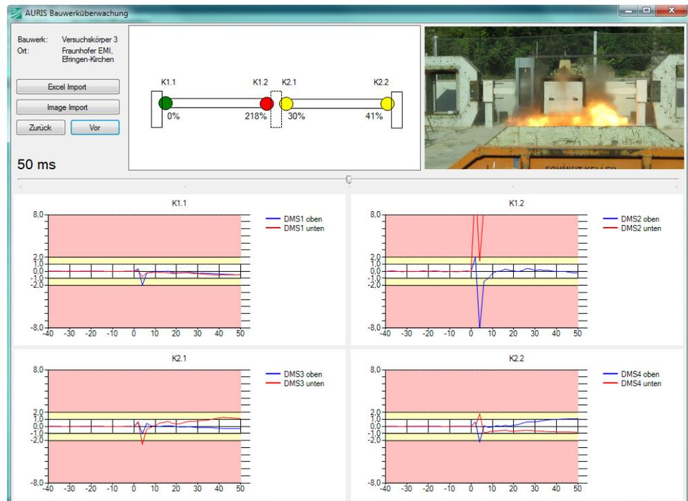
Abbildung 44: Demonstrationsoberfläche (GUI) der Kollaps-Analyse-Software. Zustand des überwachten Bauteils 50 ms nach der Zündung der Sprengladung. Knoten K2.1 und K2.2 hoch belastet (kritisch: »gelb«).
