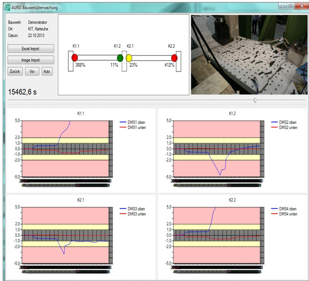
Abbildung 72: Demonstrator im Versuch nach 15463 Sekunden und einer Durchbiegung von 326 mm. Nach dem Überschreiten der Membrantragfähigkeit nimmt die Belastbarkeit mit dem endgültigen Bauteilversagen rasch ab.
