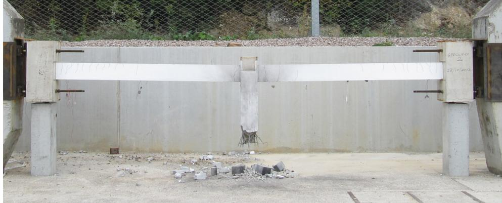
Abbildung 46: Stahlbetonversuchskörper nach der Sprengung am Fußpunkt der Mittelstütze. Aufgrund der verminderten Belastung (Belastungsgewichte wurden hier bereits wieder entfernt) blieb die Tragfähigkeit erhalten.
