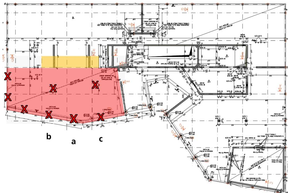
Abbildung 42: Abgrenzung unsichere/sichere Bereiche (Grundriss und Schnitt) nach initialem Schadensereignis (Ausfall EG-Randstützen »a«, »b« und »c«). Rot: Kollapsbereich, gelb: unsicherer Bereich, weiß: sichere Bereiche.
