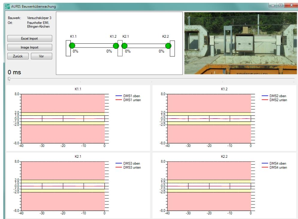
Abbildung 43: Demonstrationsoberfläche (GUI) der Kollaps-Analyse-Software. Das überwachte Bauteil im Ruhezustand vor dem Sprengversuch. Knoten K1.1 bis K2.2 unbelastet (unterkritisch: »grün«).
