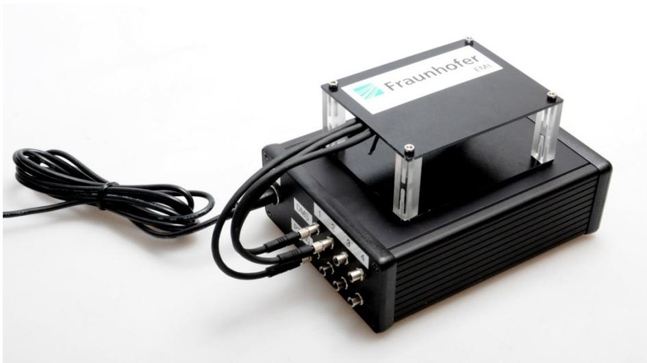
Abbildung 61: Demonstrator des lokalen Datenservers mit Dehnungs- und Temperatursensoren integriert in ein schematisches Modell eines Gebäudestockwerks.
