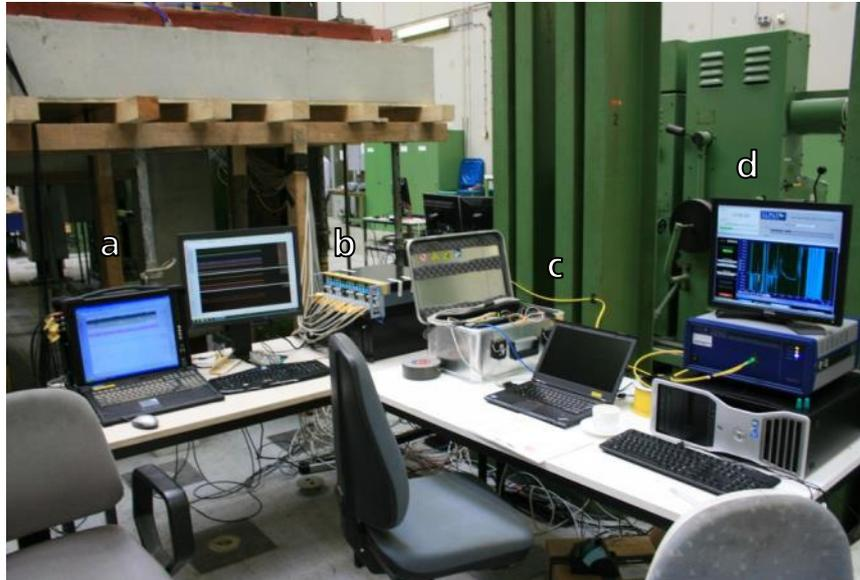
Abbildung 64: Messtechnik des Fraunhofer EMI beim Großversuch. a: Transientenrekorder für die Ultraschallsensoren. b: Messverstärker und Transientenrekorder für Dehnmessstreifen. c: Messbox mit lokalem Datenserver, Fabry-Pérot-Interrogator, unterbrechungsfreier Stromversorgung, UMTS-Router für Internetverbindung. d: ODiSI-B-System zur kontinuierlichen faseroptischen Dehnungsmessung.
