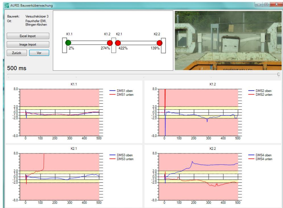
Abbildung 45: Oberfläche (GUI) der ersten Version der Kollaps-Analyse-Software. Zustand des überwachten Bauteils 500 ms nach der Zündung (Versuchsende). Knoten K1.2 bis K2.2 beschädigt/zerstört (überkritisch: »rot«).
