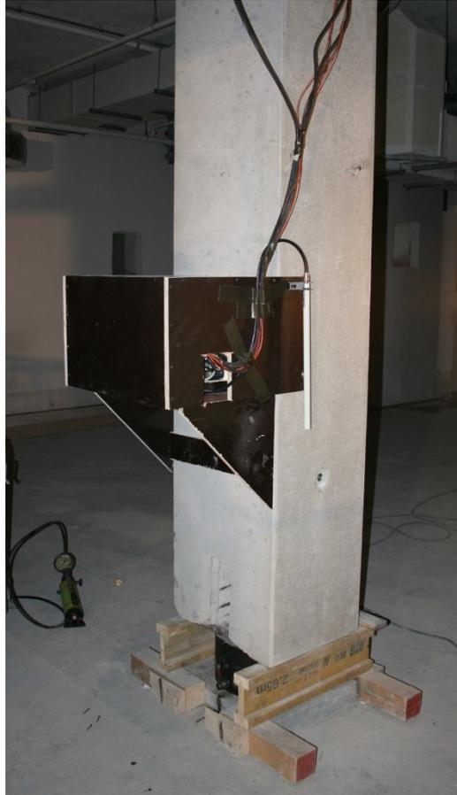
Abbildung 62: Die AURIS-Messstation an der Stütze im Untergeschoss des Taunusturms. Zu erkennen sind insbesondere die Sensorleitungen, die UMTS-Antenne zur Datenübertragung und die Presse unterhalb der Stütze.
