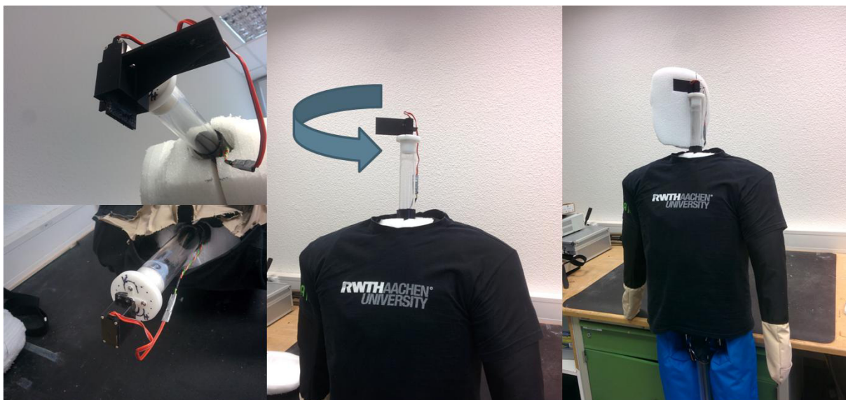
Abb. 2-25: Umbau des FG-Dummys zur Darstellung der Kopfbewegung
