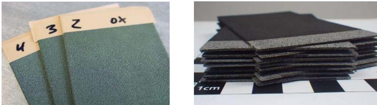
**Abbildung 6: Unbeschichtete Schaumblätter maskiert (links) sowie beschichtete Schaumproben (rechts) zum Aufbau von Demonstratorzellen im Pouch-Design.**
