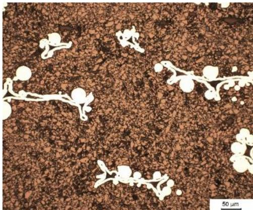
Mikroskopische Aufnahme einer Probe der Serie „Rakel 1“ mit 39 M% gravimetrische Beladung (35 M% Hard Carbon)
