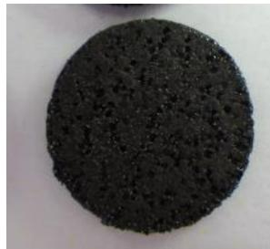
**Abbildung 2:** In625 Schaumscheiben (Durchmesser 10 mm, Dicke 900 µm) nach Infiltration mit Hard Carbon mittels Rakeltechnik (links) bzw. Nasspulversprühen (rechts).
