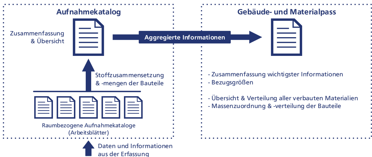
Abbildung 20: Aufbaustruktur des Gebäude- und Materialpasses.
