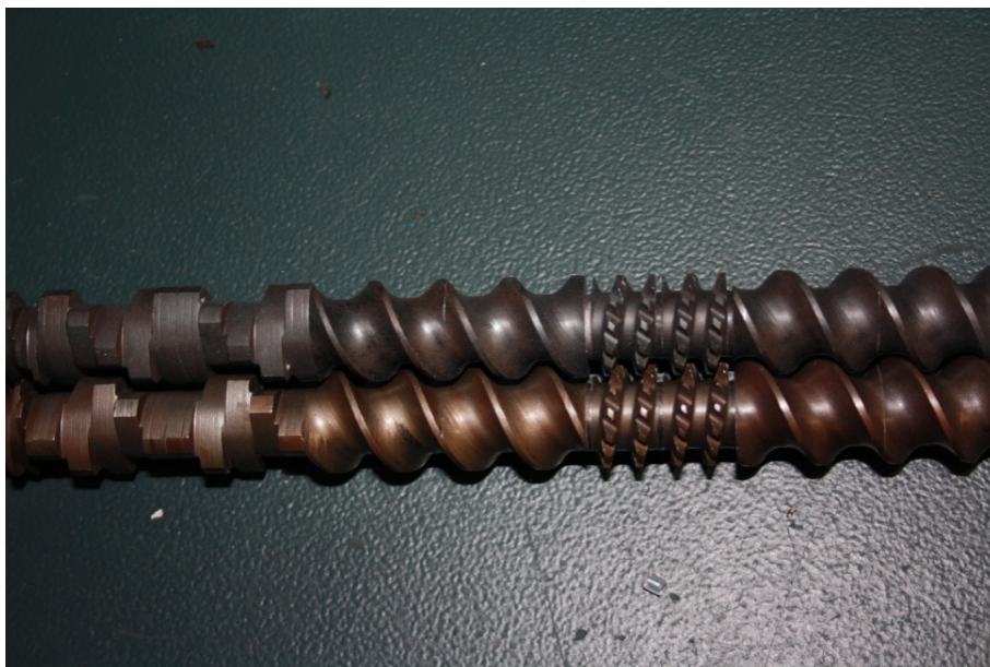
Abbildung 29: Verfärbung der Extruderschnecken nach der Verarbeitung von Galden HT230. Oben nach Sandstrahlung, unten vor Sandstrahlung.
