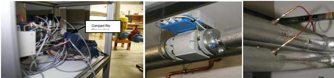
**Bild 10** Gestell mit Drucktransmittern, CompactRio-System und el. Einbindung
