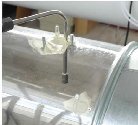
**Bild 38** Eindüsungsposition Rohrmittle
