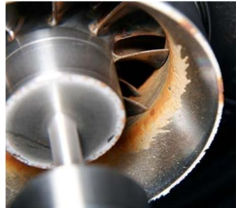
Bild 61 Fouling am Verdichter
