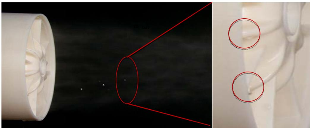
**Bild 43** Darstellung der Tropfenbildung an den Kühlrippen
