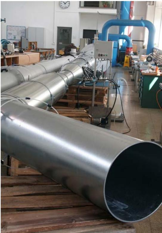
**Bild 21** Aufbau der Ansaugstrecke am Axialventilator
