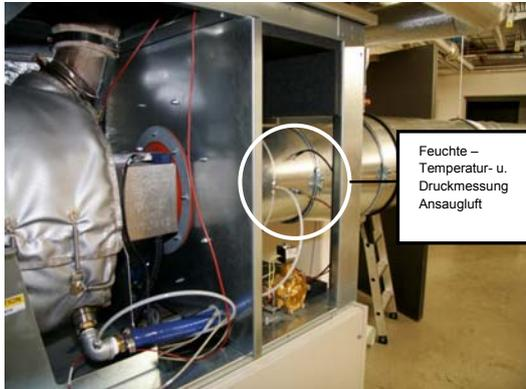
**Bild 13** Messstellen zur Erfassung der Ansaugtemperatur, -feuchte und des -druckes
