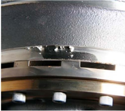
**Bild 53** Spuren flüssigen Wassers am Diffusor
