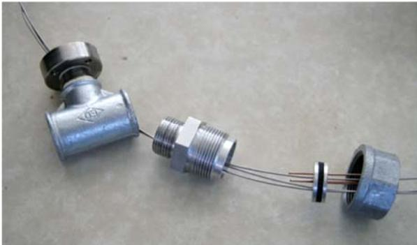
**Bild 16** Verschraubung für die verdichterseitigen Messstellen
