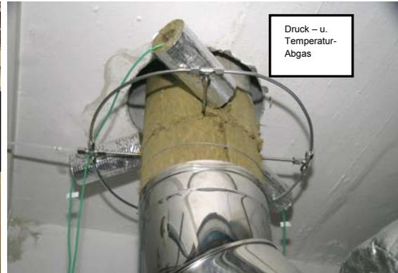
**Bild 14** Messstellen zur Erfassung der Abgastemperatur und des Abgasdruckes
