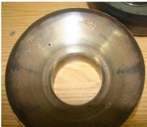
**Bild 55** Einlaufblech mit starken Korrosionsspuren
