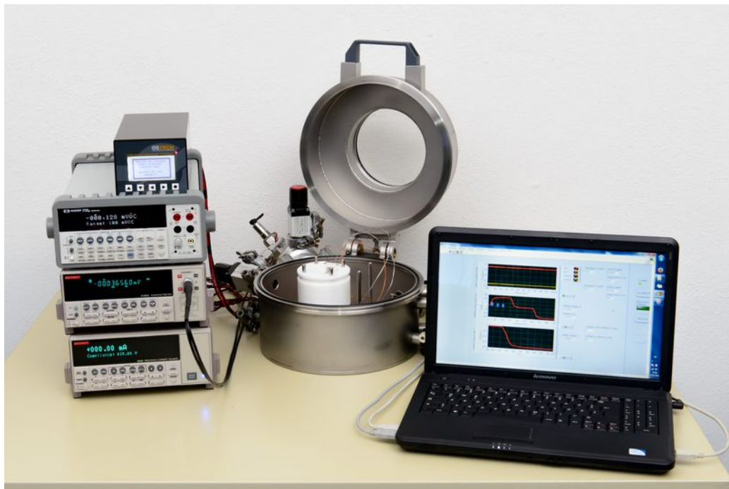
Abbildung 1: Der Seebeck Messplatz befindet sich in einer Vakuumkammer, so dass die Messungen im Vakuum durchgeführt werden können.
