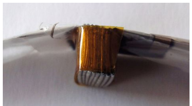
Abbildung 8: Der Streifen wird mäanderförmig aufgefaltet und zu einem kompakten Block verpresst.
