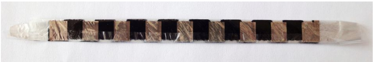
Abbildung 7: Das komplett mittels Siebdruck hergestellte Layout wird aufgerollt, so dass ein langer Streifen entsteht, der aus mehreren übereinander liegenden Lagen besteht.
