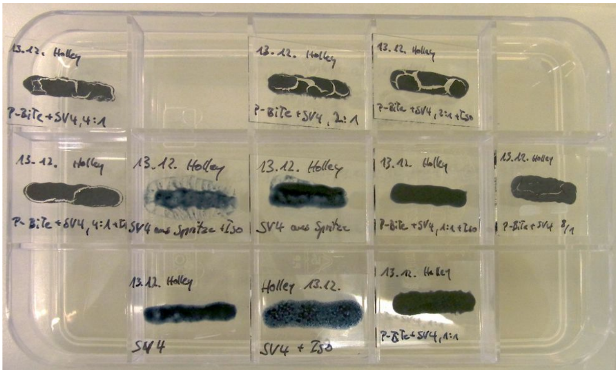
Abbildung 5: \text{Bi}_2\text{Te}_3 in Form von Mikropartikeln dispergiert in PEDOT:PSS S-V4. Je nach Mischungs- und Verarbeitungsparametern ergeben sich Filme mit unterschiedlichen mechanischen Eigenschaften, die von hart und brüchig bis zu weich und elastisch reichen und sich somit für den Einsatz auf flexiblen Substraten eignen würden.
