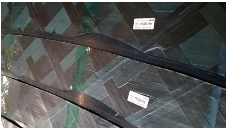
Abbildung 48 Roboterbeschnitt Bauteil Preformen
