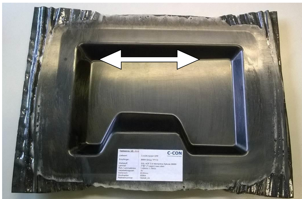
Abbildung 25 Ondulationen (verschwommene Fasern )
