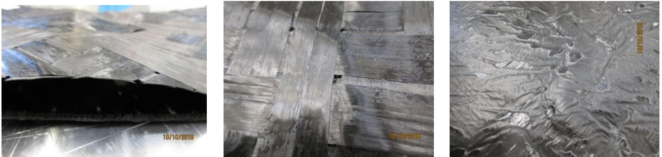
Abbildung 27 Unregelmäßigkeiten und Trockenstellen bei VR 01
