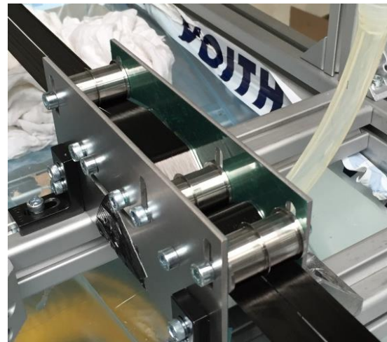
Abbildung 60 Imprägniermodul zweite Generation auf Versuchsstand
