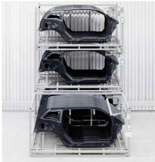
Abbildung 2 Seitenrahmen des BMW i3; hergestellt im HD RTM-Prozess
