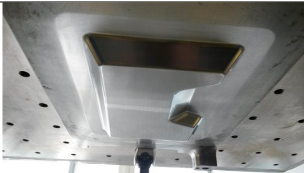
Abbildung 21 - Schikane-WZ, Pressen - Oberwerkzeug
