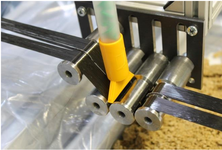
Abbildung 58 Imprägniermodul erste Generation
