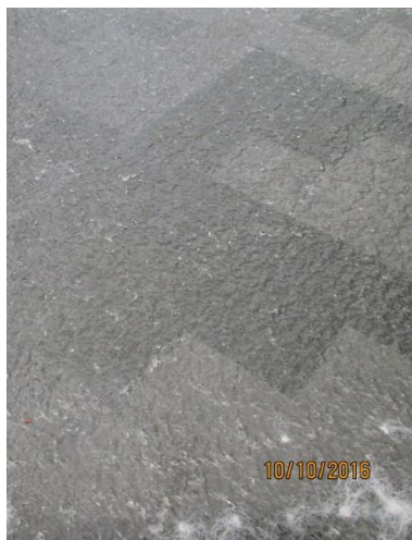
Abbildung 29 Verbesserte Imprägnierung VR 03 (harzreich links; harzarm rechts)
