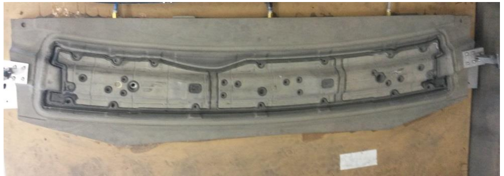
Abbildung 41 Fräsaufnahme Windlauf oben
