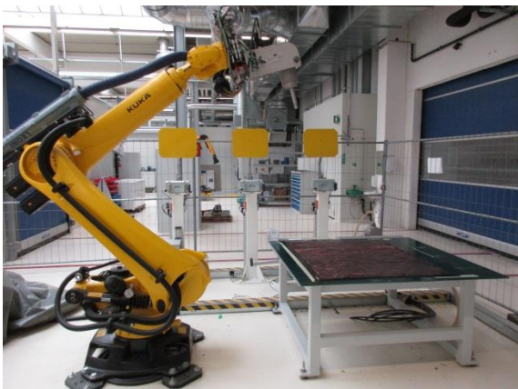
Abbildung 63 Roboter mit Ultraschallmesser
