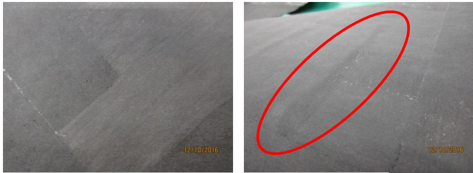
Abbildung 30 Harzreiche Seite VR 08 mit Abreißgewebe
