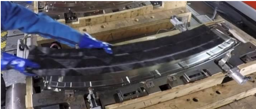
Abbildung 38 Einlegen der Preform in das Presswerkzeug
