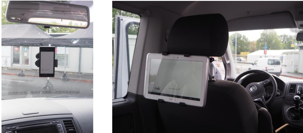
Abbildung 19: Smartphone und Tablet im Demo-Fahrzeug zur Visualisierung der RSE-Warnungen
