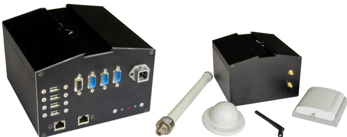
Abbildung 42: ifak Test-RSU/AU mit verschiedenen Antennen
