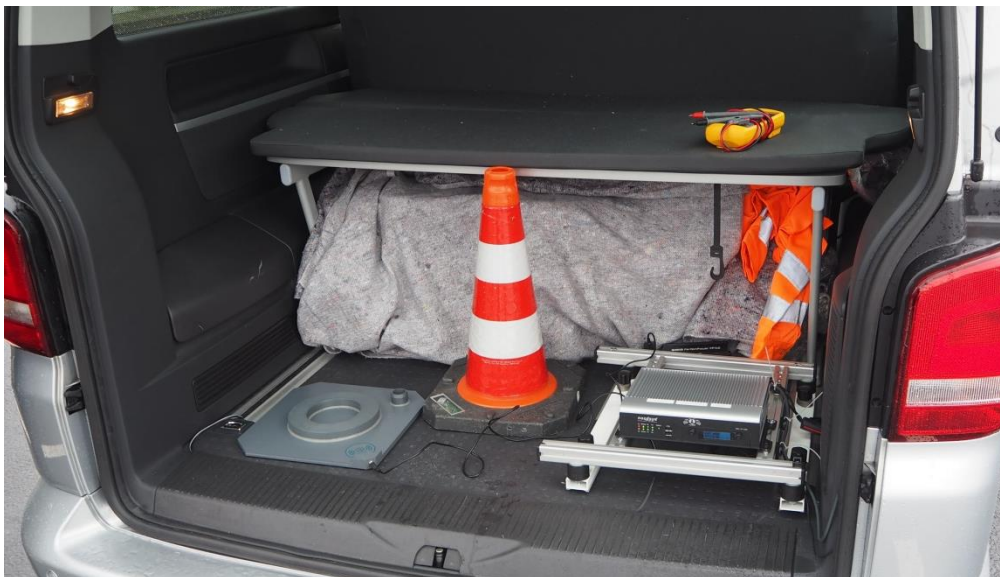
Abbildung 18: Leitkegel-Ladeschale, Leitkegel (SK35) und Wavebee auf Gestell
