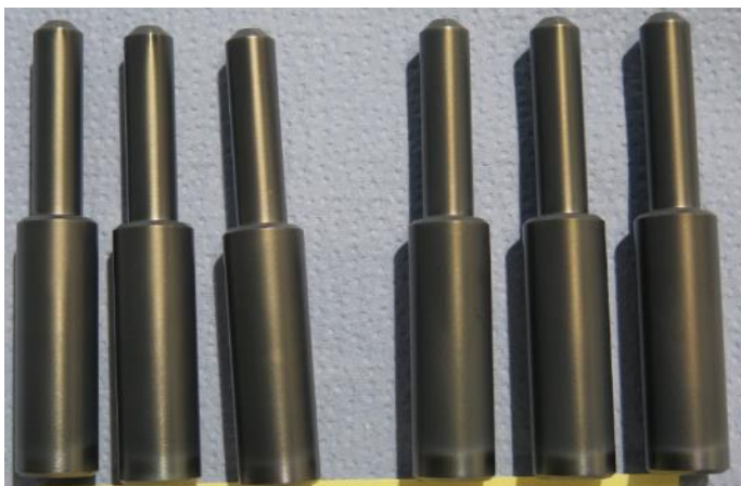
Abbildung 51: Tribodorne nach der Beschichtung (links: 3 Dorne Charge: C2467; rechts: 3 Dorne Charge C2468)
