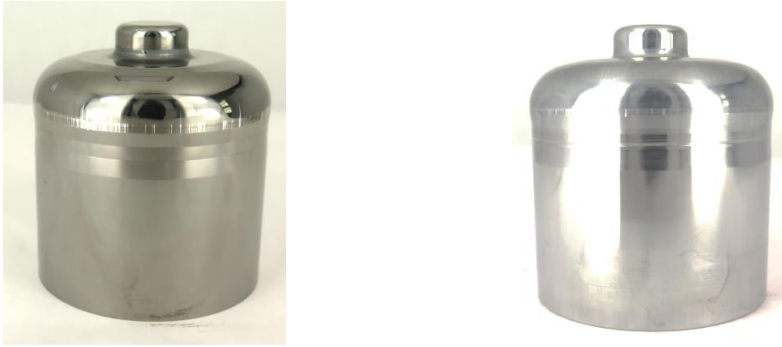
Abbildung 52: Werkzeuge der Geometrie 2515 von alutec nach Einsatztest (links: Werkzeug 2515-00-10-01/A #4 beschichtet mit TiAlWN (Charge C2452) nach Fertigung von 2 Teilen; rechts: Werkzeug 2515-00-10-01/B #1 unbeschichtet nach der Fertigung von 10 Teilen)
