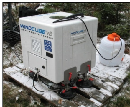
Abbildung 36: LiDAR Windcube V2 während der Messkampagne am Rödeser Berg
