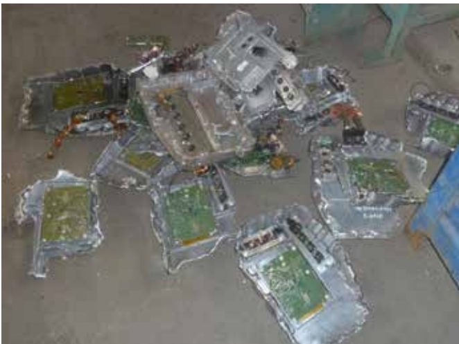
Abbildung 16 Gehäusebestandteile ohne vollständigen Aufschluss – Wiederaufgabe (Quelle ECG)
