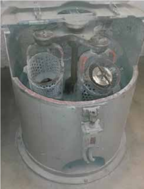
Abbildung 23 genutzte Planetenkugelmühle am IFAD (Quelle ECG)
