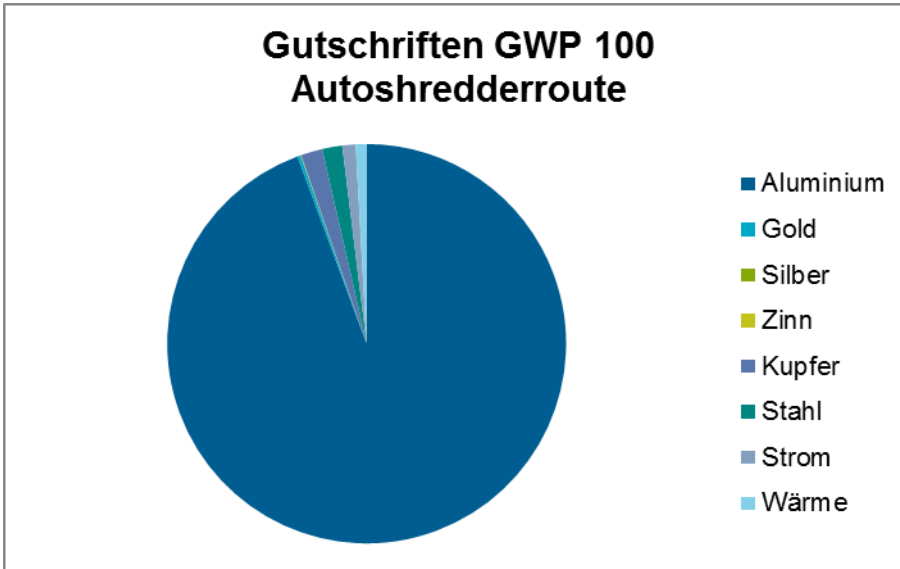
Abbildung 5-3: GWP: Gutschriftenanteile für die Autoshredderroute
