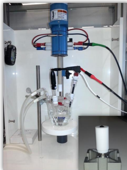
Abbildung 4: Elektrochemischer Schnelltest. 3-Elektroden Aufbau und vergrößerte Darstellung der Arbeitselektrode die mit einer CDC Suspension beladen wird.
