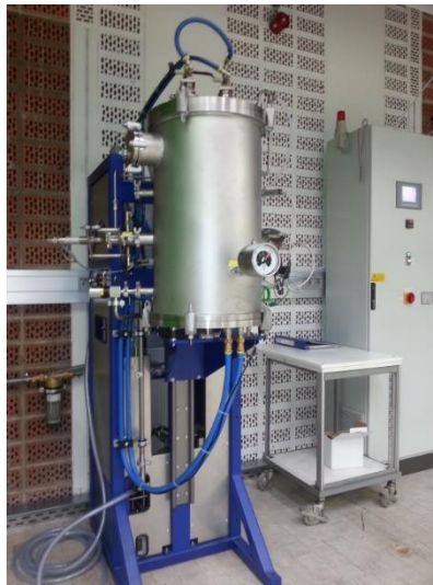
Abbildung 18: Graphit-Hochtemperaturofen zur Realisierung des Vakuumausheizens von Kohlenstoff.
