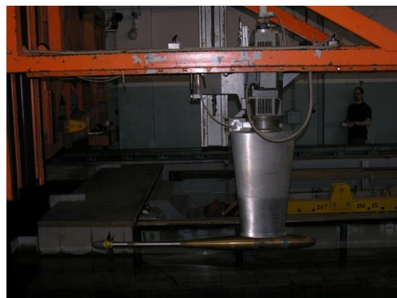
Abbildung 7: Versuchsaufbau für die 4-Quadrantenmessungen
