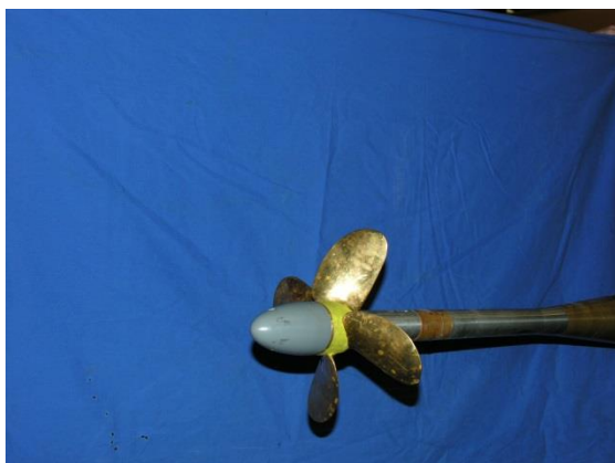
Abbildung 7: Versuchsaufbau für die 4-Quadrantenmessungen
