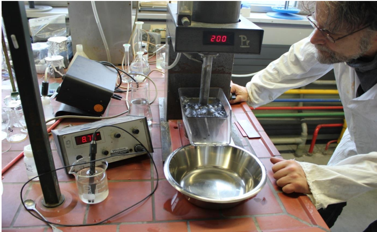
Abbildung 18: Versuchsstand für Flotationsversuche mit Haldenmaterial Bergwerkswohlfahrt
