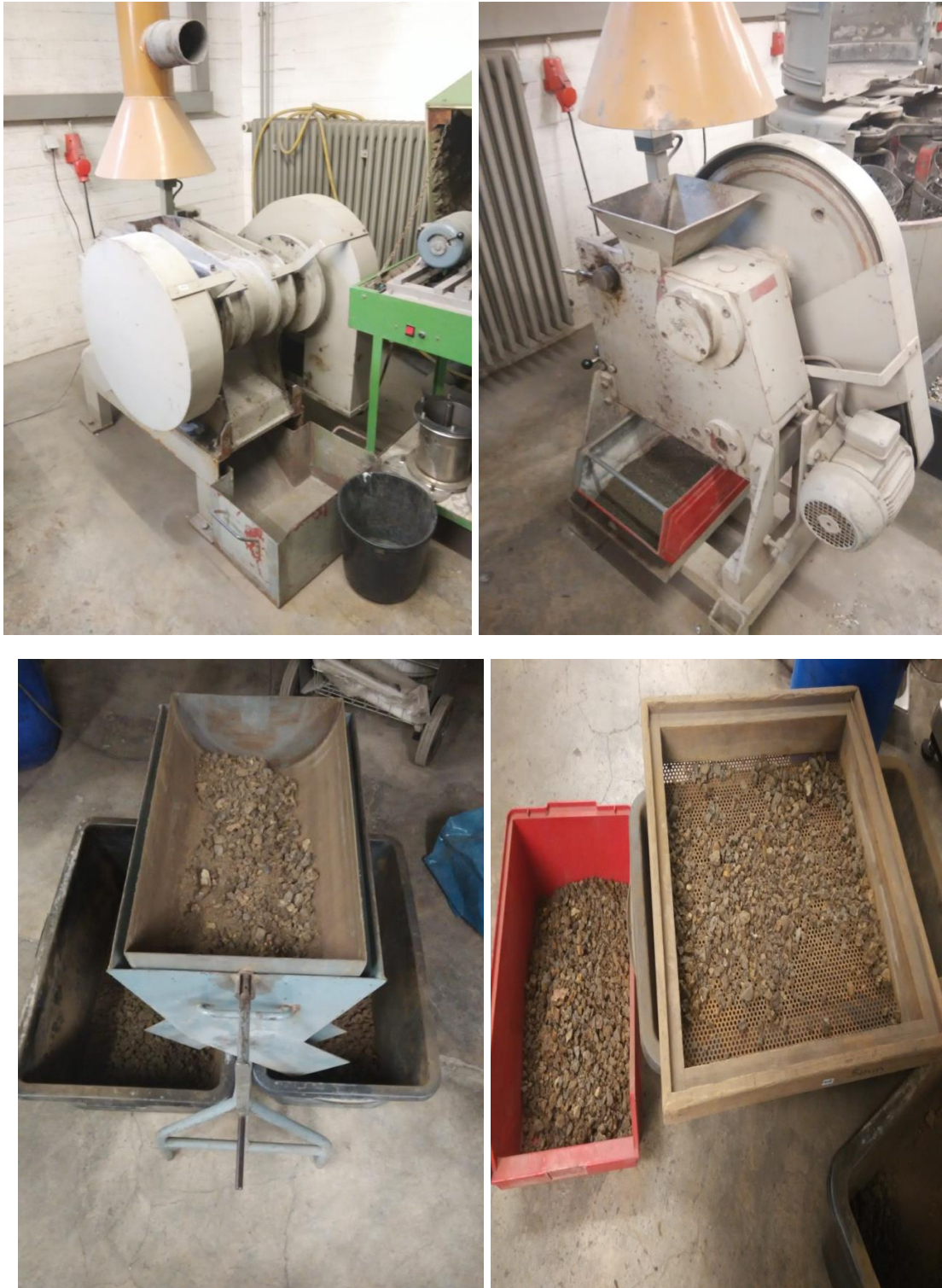
Abbildung 29: Fotos bei der Probenzerkleinerung und Siebung des Materials der Schlackenhalde Langelsheim
