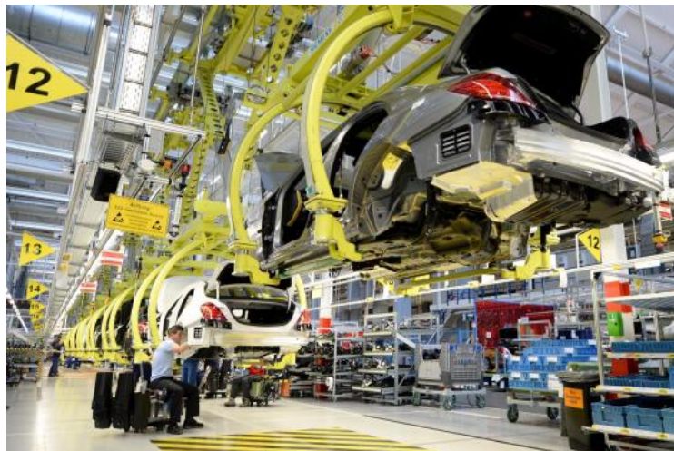
Abbildung 1: Daimler Pressebild: Beispiel einer Produktionslinie in der PKW-Fertigung. Die zu verbauenden Teile pro Pkw (ca. 4.000-10.000) müssen rechtzeitig an den 20 Bearbeitungsstationen in der Montage bereitgestellt werden. Im Zweischichtbetrieb arbeiten meist drei Werker in einem Team pro Station und können bei Bedarf durch sogenannte Springer unterstützt werden. ©Daimler AG.
