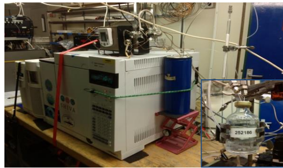
Massenspektrometer zur Messung von Schwefelverbindungen und Isopren
