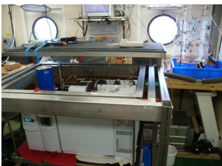
Massenspektrometer zur Messung von Halogenkohlenwasserstoffen im Meerwasser
