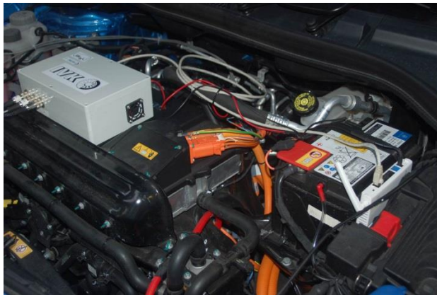
Abbildung 24: Positionierungssteuergerät im Motorraum der B-Klasse.
