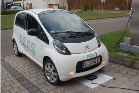
Abbildung 19: MPPS. Links: Elektrofahrzeug über der Ladespule. Rechts: 3D-Anzeige der Position der Ladespule (Empfängerspule rot, Ladespule blau). Fotos: Universität Stuttgart/IVK [5].
