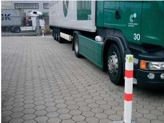
*Abb. 11 - Lichtschanke längs des Fahrzeuges*
