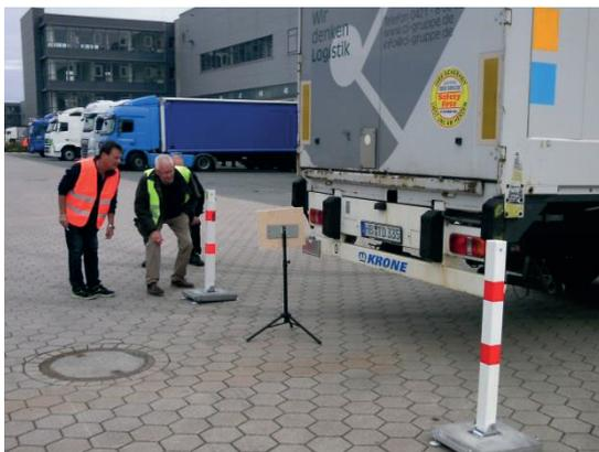
Abb. 10 - Justage der Säulen mit Hilfe der Reflektortafel
