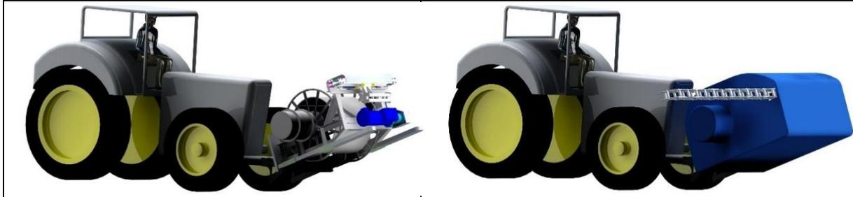
Abbildung 5.3.1 Leitungsführungssystem am vorderen Hubwerk: ohne und mit Gehäuse
