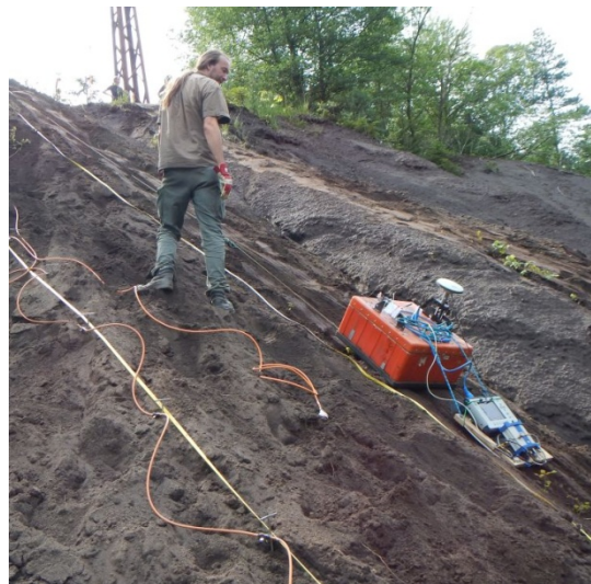
Abb. 2.31: GPR Messungen am Hang mit geschirmter 200 MHz Antenne und GPS Empfänger.
