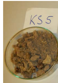
Abb. 3.4: Die Heterogenität der Schlacken zeigt sich bereits makroskopisch.
