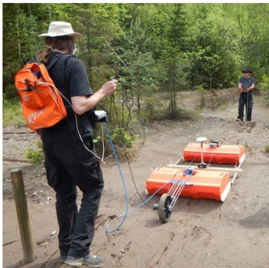
Abb. 2.30: GPR Messungen in der Ebene mit 100 MHz Antenne (separate Sende- und Empfängerantenne) und GPS Empfänger sowie Markerrad.
