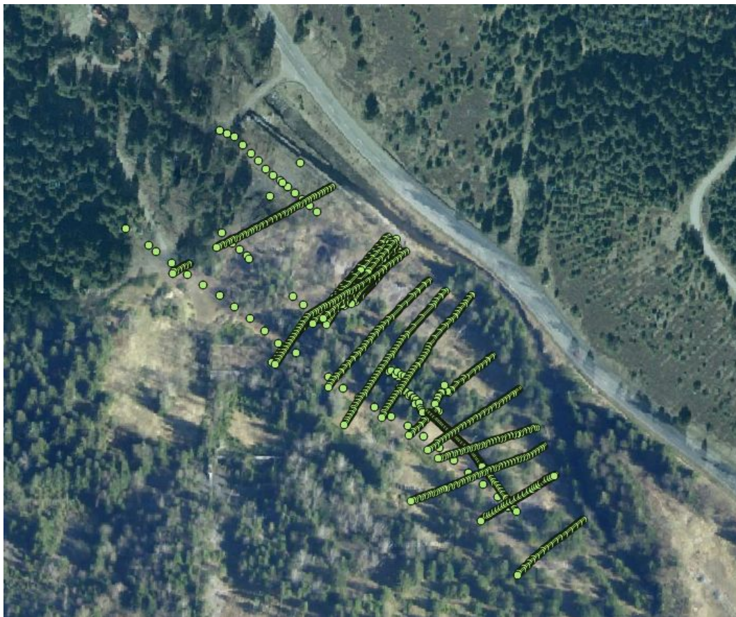
Abb. 2.22: Lage der ERT Profile. Die grünen Punkte symbolisieren die auf den Profilen aufgenommenen GPS Messpunkte.
