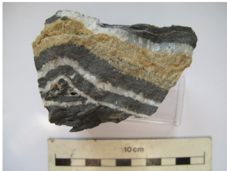
Abb. 2.1: Primärerz der Grube Bergwerkswohlfahrt. Die Ag-, Sb- und Pb-reiche Vererzung (dunkelgrau) ist verwachsen mit unterschiedlichen Gangmineralen, wie Quarz (linkes Foto, weiße Phase), Baryt (rechtes Foto, weiße Phase), Siderit (hellbraun) und anderen Karbonaten, sowie Nebengestein.
