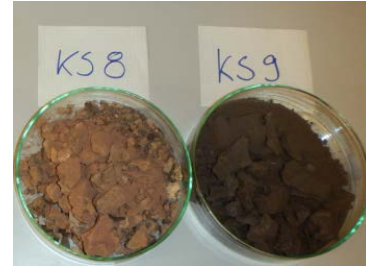
Abb. 3.4: Die Heterogenität der Schlacken zeigt sich bereits makroskopisch.
