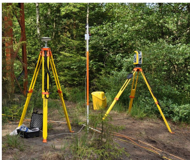
Abb. 2.21: Positionierungsmessgeräte zur genauen Aufnahme der Topographie und der Lage der Messpunkte.
