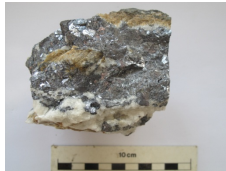
Abb. 2.1: Primärerz der Grube Bergwerkswohlfahrt. Die Ag-, Sb- und Pb-reiche Vererzung (dunkelgrau) ist verwachsen mit unterschiedlichen Gangmineralen, wie Quarz (linkes Foto, weiße Phase), Baryt (rechtes Foto, weiße Phase), Siderit (hellbraun) und anderen Karbonaten, sowie Nebengestein.
