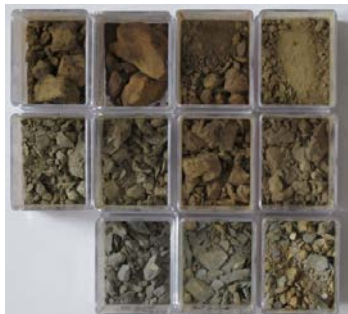
Abb. 2.7: Die Pochsandhalde enthält verschiedene Aufbereitungsrückstände von der Kies- bis zur Tonfraktion. Mit abnehmender Korngröße nehmen die durchschnittlichen Blei-, Antimon-, Silber- und Zinkgehalte zu. Die Konzentrationen sind als Anhaltspunkte zu verstehen, da in die Berechnung dieser Konzentrationen nur Teilproben einiger Bohrungen eingingen (K, R, Q, M, S, I, L).
