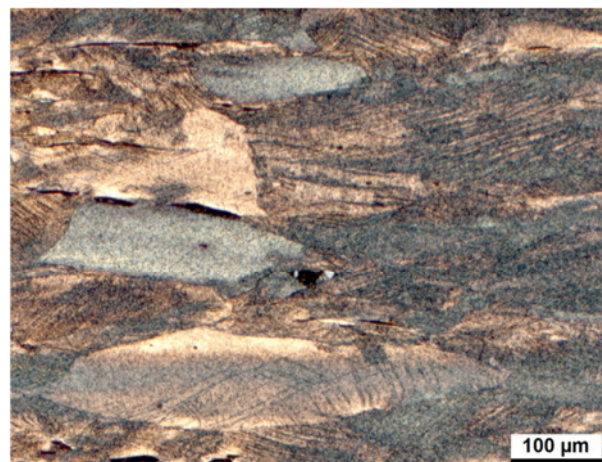
Abb. 15: Gefüge W24 im Längsschliff (Ätzmittel: Beraha II) a) kaltverfestigter Ausgangszustand (+C) b) Zustand nach dem Zugversuch im Bereich der Gleichmaßdehnung (Probe 41.8)
