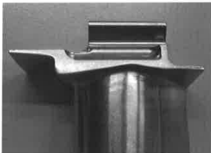
Abb. 16: Detail einer fertig bearbeiteten TiAl Schaufel
