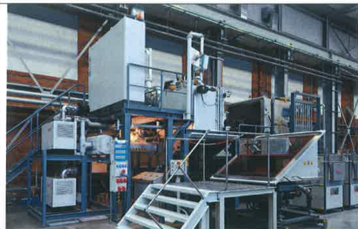
Abb.8: Leicomelt Vakuum Schleudergießanlage mit KIT (Kaltwandinduktionstigel)
