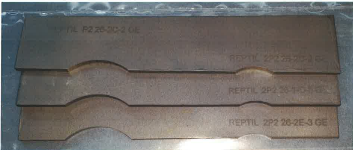
Abb.13: auslieferfertige GE Platten P2 T mit je zwei künstlichen Kaltläufen
