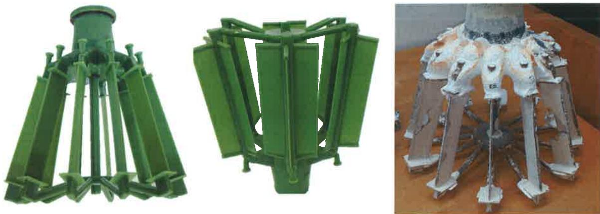
Abb.7: zwei im Projekt verwendete Wachscustervarianten zur Herstellung der im Projekt verwendeten Plattenproben und eine für das Freistrahlen vorbereitete Formschale nach dem Abguss (rechts)
