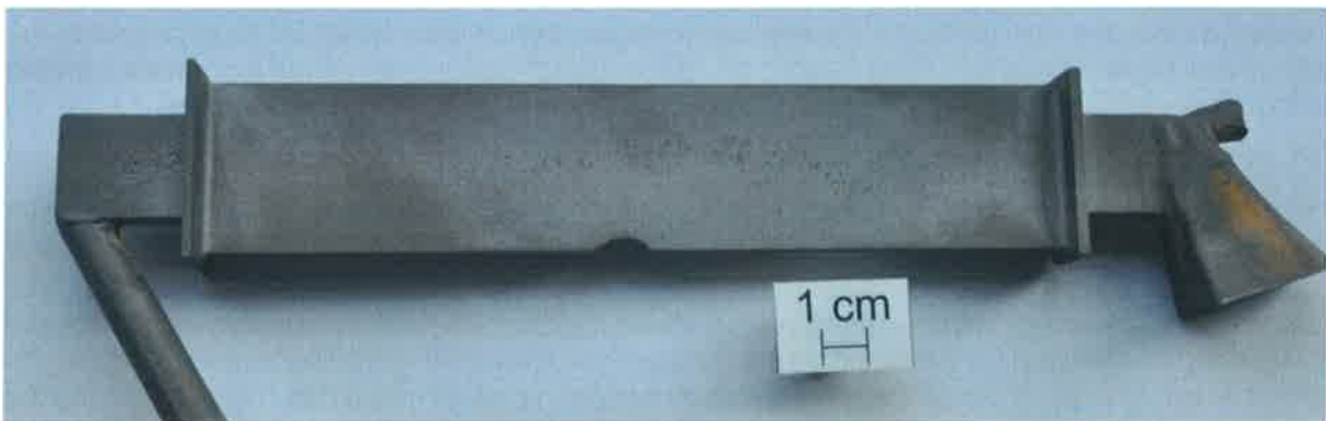
Abb.4: kleiner realer Kaltlauf an einer TiAl Dummieschaufel mit Angusssystem
