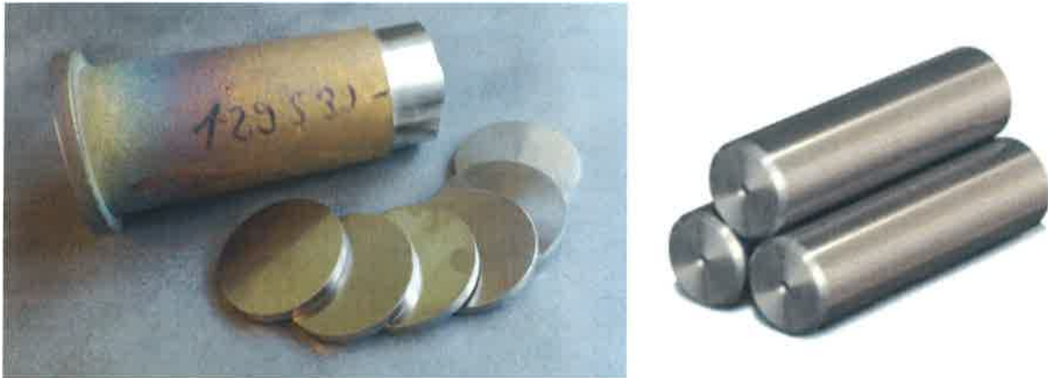
Abb.22: von ACCESS für die Pulververdüstung gegossener Billet Rohling (teillbearbeitet mit Testscheiben) (links), fertig bearbeitete Billets für den Einsatz in der Verdüstungsanlage (rechts)
