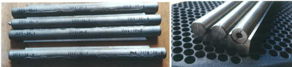
Abb.9: Stabrohlinge nach Freistrahlen und Abtrennen vom Gießcluster und 3 fertig bearbeitete Stäbe (rechts)
