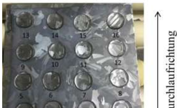
Abbildung 25: Gasphasentestwafer 4x4 Positionen, mit definierte Menge KOH-Lösung.
