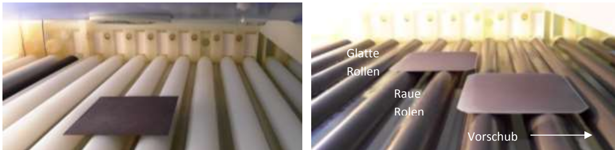
Abbildung 2: PSG Wafer auf geriffelten Kunststoffrollen (links) und auf Schwammrollen (rechts)
