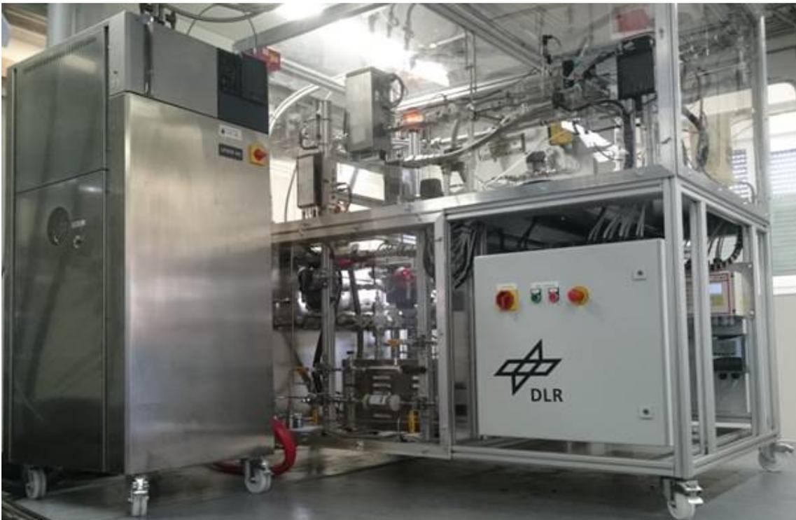
**Abbildung 11:** Brennstoffzellenlaborteststand mit Huber Temperiergerät (Unistat 615W).
