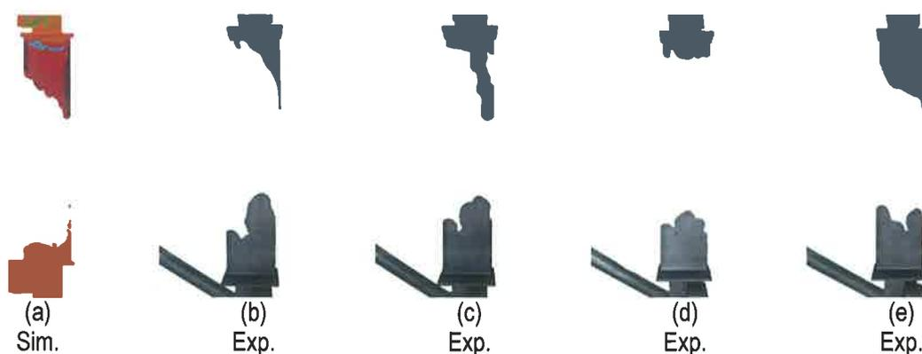
**Abbildung 2.15:** Gegenüberstellung der numerisch berechneten Formfüllung mit der Gestalt realer Gussteile mit  $d = 1\text{ mm}$  für die Legierung GE 48-2-2
