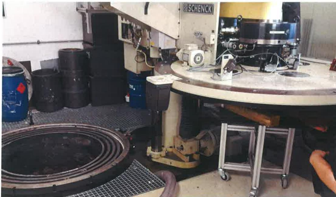
**Abbildung 2.29:** Schleudertest-Anlage
