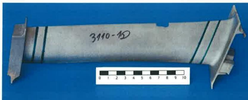
**Abbildung 2.5:** Gegossene TATT-Schaufel mit Kaltlauf
