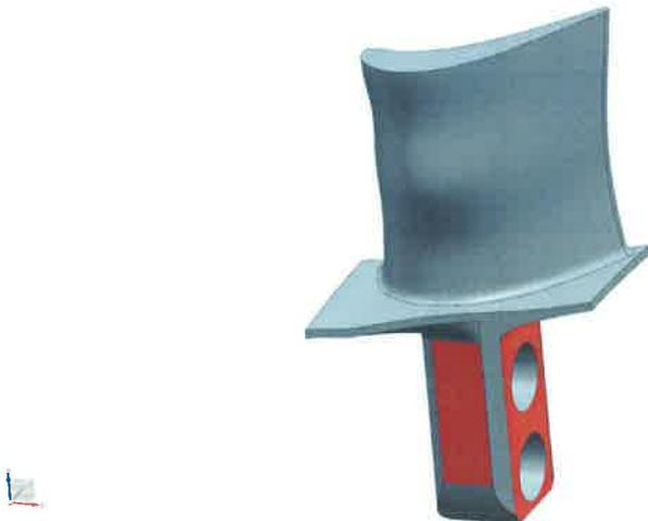
**Abbildung 2.26** HPT-Turbinenschaufel im Endzustand
