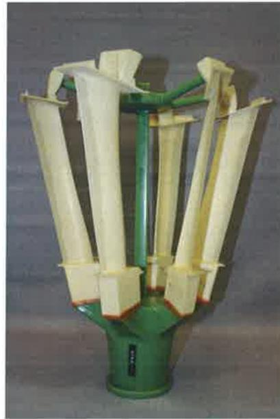
**Abbildung 2.4:** Gießaufbau mit RP-Modellen
