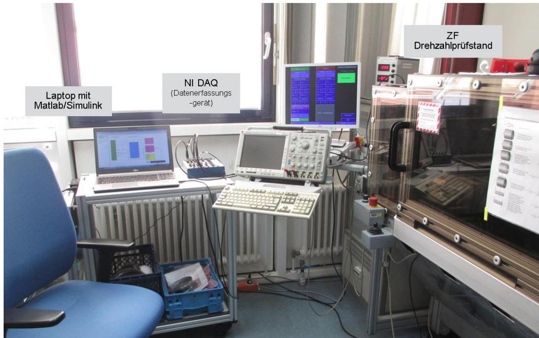
Bild 26: Prüfanordnung Drehzahlprüfstand
