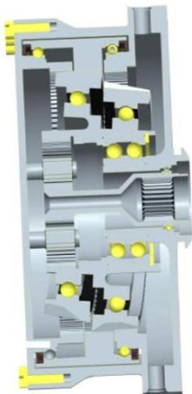
Bild 11: Entwurf FS-GRA Aktuatorgetriebe
