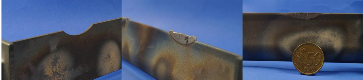
Bild 22: Kleiner künstlicher Kaltlauf an einer Dummyschaufel im Ausgangszustand (links), nach dem Reparaturschweißen (mitte) und nach Abschleifen überstehenden Materials (rechts). Verfärbungen der Blade sind auf Erwärmungsversuche mit unterschiedlichen Induktionsspulen zurückzuführen.
