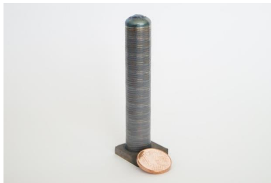
Bild 16: GE4822, laserauftraggeschweißt, 750°C Vorheizung, Bauhöhe 63mm
