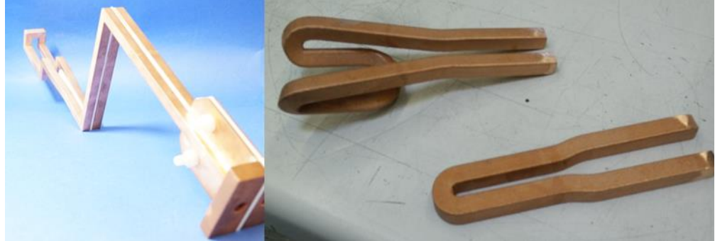
Bild 29: links: durch Verbindungslöten hergestellte Kupferinduktionsspulen für kleine künstliche Kaltläufe Breite/Durchmesser Kupferrohr: 8 mm rechts: SLM-Induktionsspulen aus CuCr0,1Zr0,1, abgetrennt und wärmebehandelt
