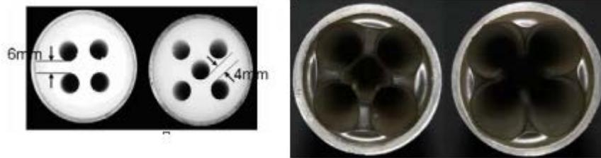
Abbildung 4: Multi-Port Hybridantrieb vor (a) und nach dem Test (b) [4]
