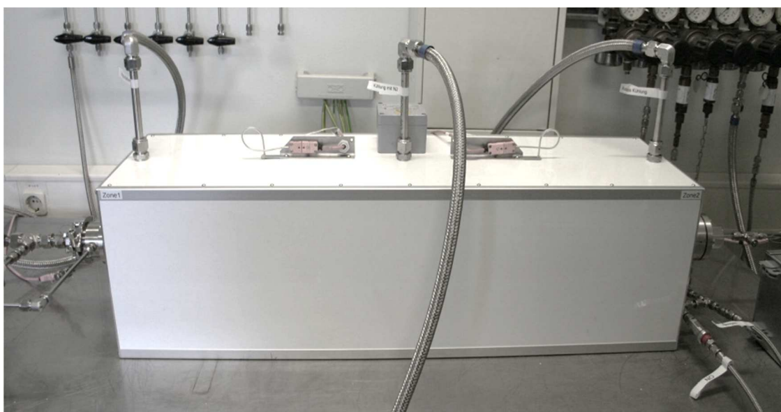
Abbildung 3: Synthesegasanlage bei HDE
