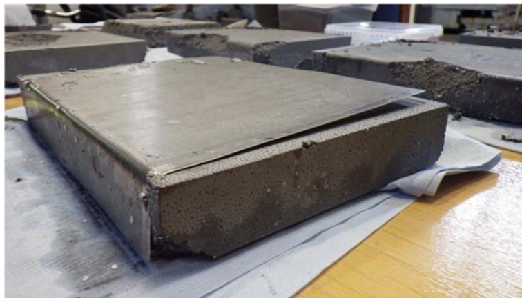
Bild 13 Formkörper mit Lochblech. Im Hintergrund Formkörper mit Entformungsdefekten.
