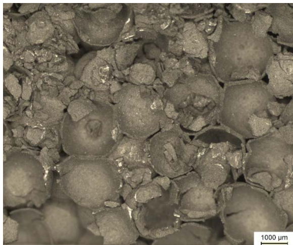
Bild 54 Bruchfläche der Probe 1051 (Bewegungsrichtung der Finne hier von unten nach oben).
