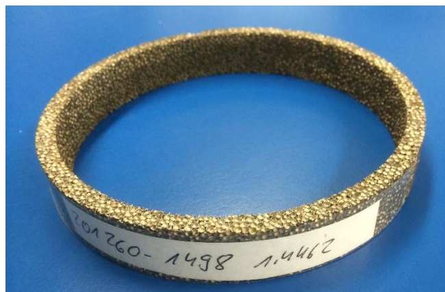
Bild 27 Demonstrator Pumpendichtring (Außendurchmesser 130 mm).
