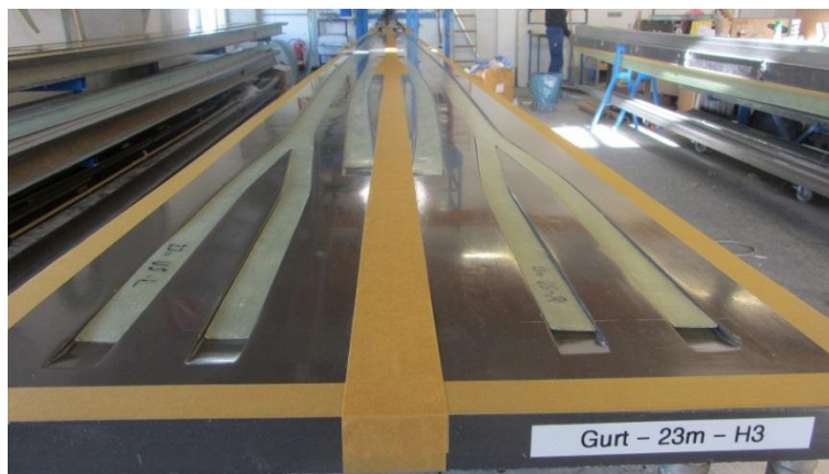
Abbildung 7: Eine von zwei Hauptholgurtformen für die Antares H3
