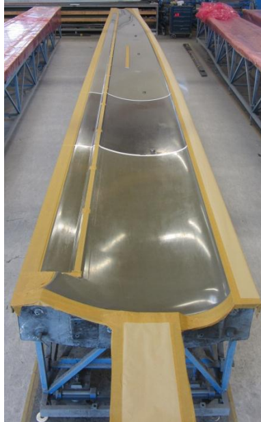
Abbildung 6: Eine von 4 Tragflächenformen für die Antares H3
