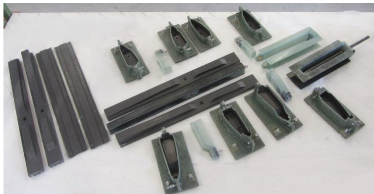
Abbildung 8: Satz Formen für die rechte und die linke Außentragflächenteilung
