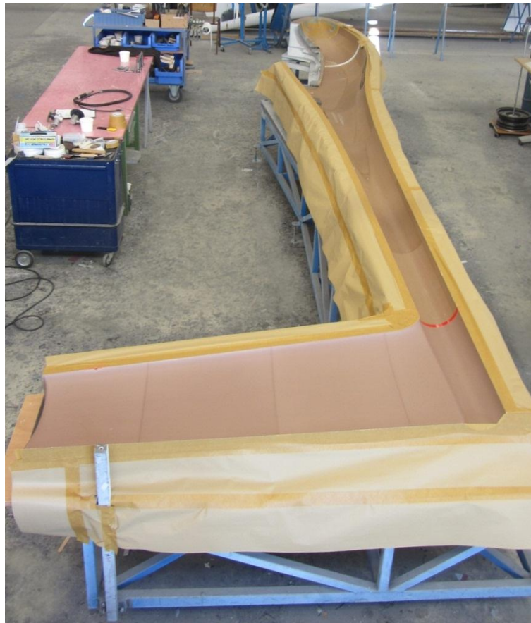
Abbildung 9: Neue Formen für die Seitenleitwerkssektion an vorhandener Rumpfform angesetzt
