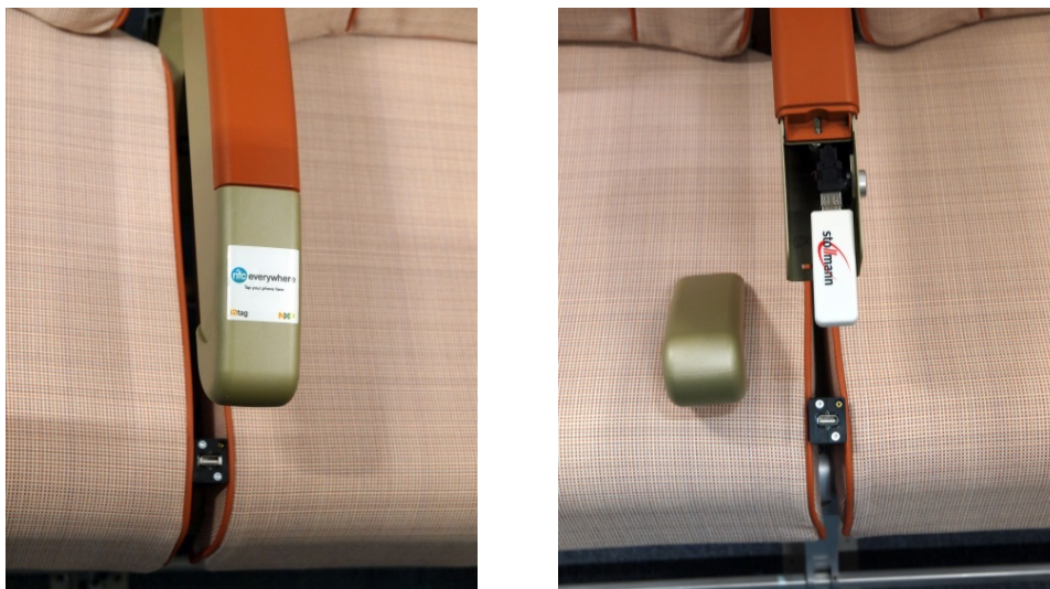
Abbildung 42: NFC-Varianten am Passagiersitz: passiver NFC-Tag (links) und Antenne des aktiven NFC-Reader-Moduls in der Armlehne (rechts)
