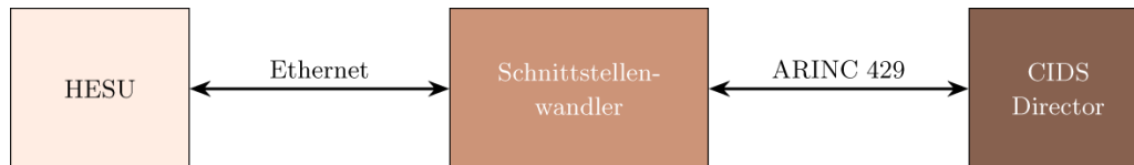
Abbildung 31: Schnittstellenwandler für den ARINC 429-Bus des CIDS Directors [Spe16]
