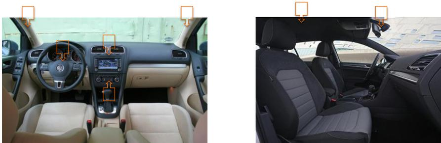
**Abbildung 4.1.1** Mögliche Verbau-Orte von Kamerasensorik im Fahrzeuginnenraum
