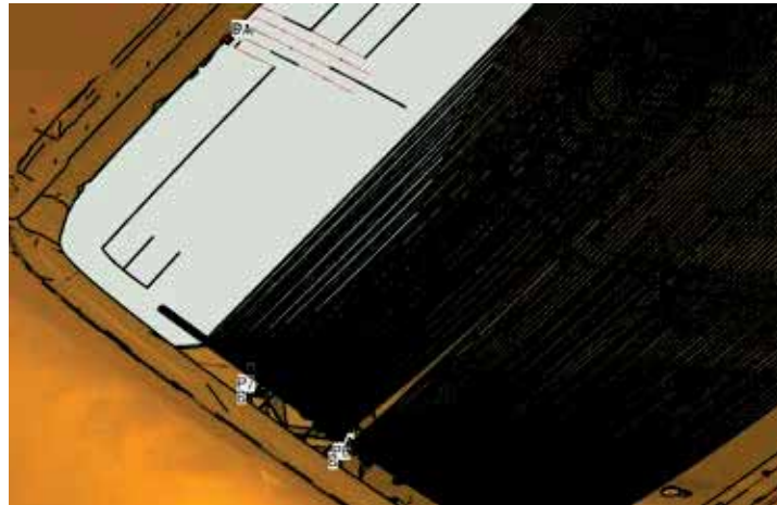
Abbildung 7: Vereinfachtes Simulationsmodell; hier Heiz- und Antennenstrukturen
