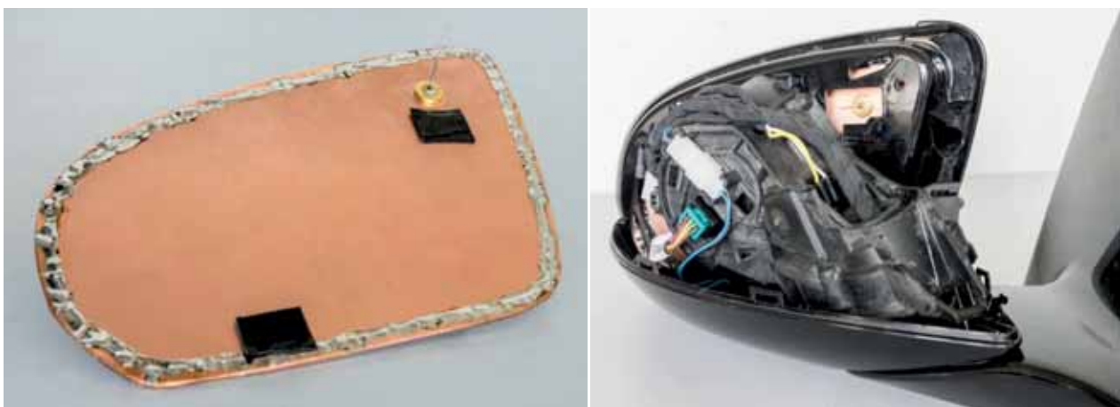
Abbildung 23: Monopolantenne im Spiegel des W222
