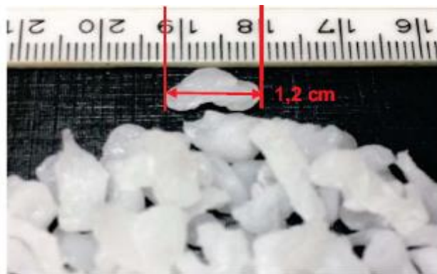
Abbildung 16: PCM-Pellets bestehend aus einem Phasenwechselmaterial auf Paraffinbasis eingebettet in eine stabile Polymerstruktur.
