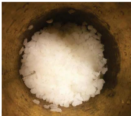
Abbildung 21: Verklumptes PCM-Material im Container nach einem Aufheiz- und Abkühlversuch durch den Phasenwechselbereich des Materials.
