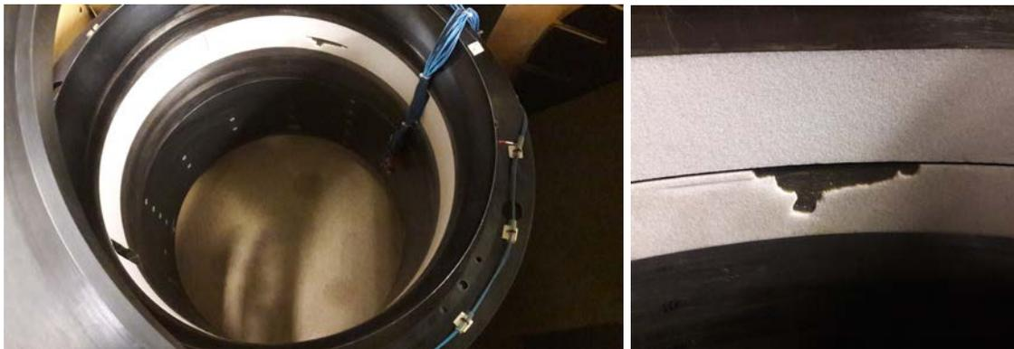
Abbildung 57: Abgelöster Anlaufbelag über dem Rotor.
