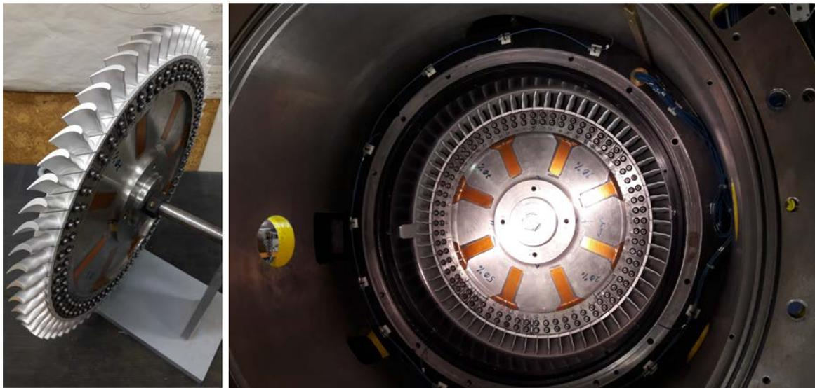
Abbildung 43: Optimierte Aluminiumschaufeln installiert in die Rotorscheibe (links) und in den Prüfstand (rechts).
