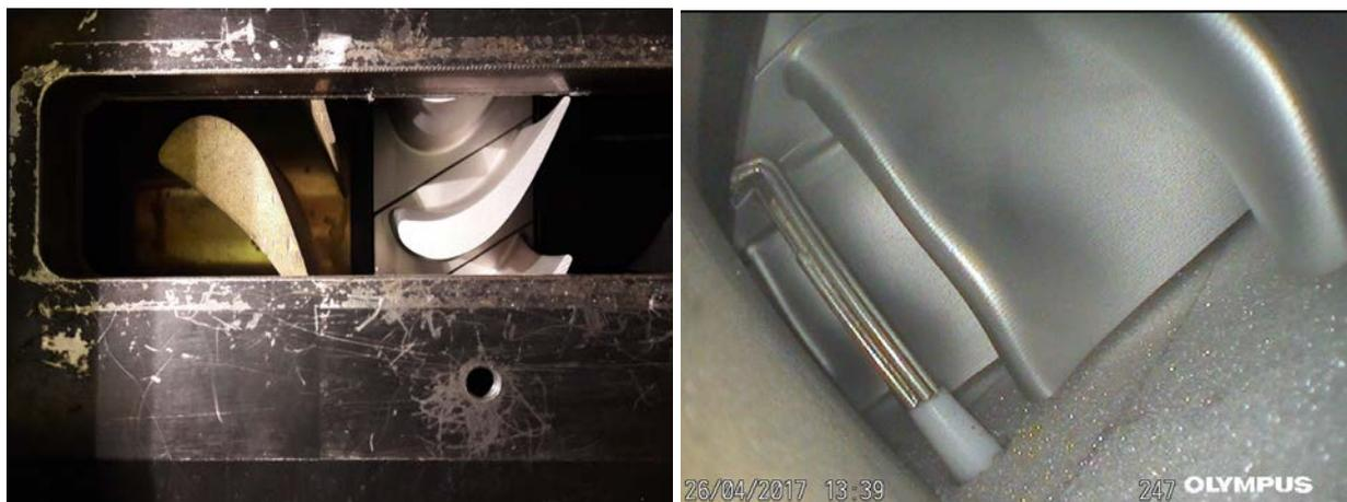
Abbildung 44: links: Blick durch die Gehäuseöffnung des Prüfstands, rechts: Boroskopische Untersuchung der Sondenpositionierung zwischen Stator und Rotor.
