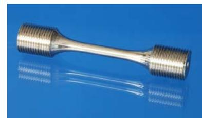
Abbildung 2: Geometrie der mittleren Probengröße  $D = 4\text{mm}$  (links); von Access hergestellte Rundprobe aus TiAl mit  $D = 4\text{mm}$  (rechts).
