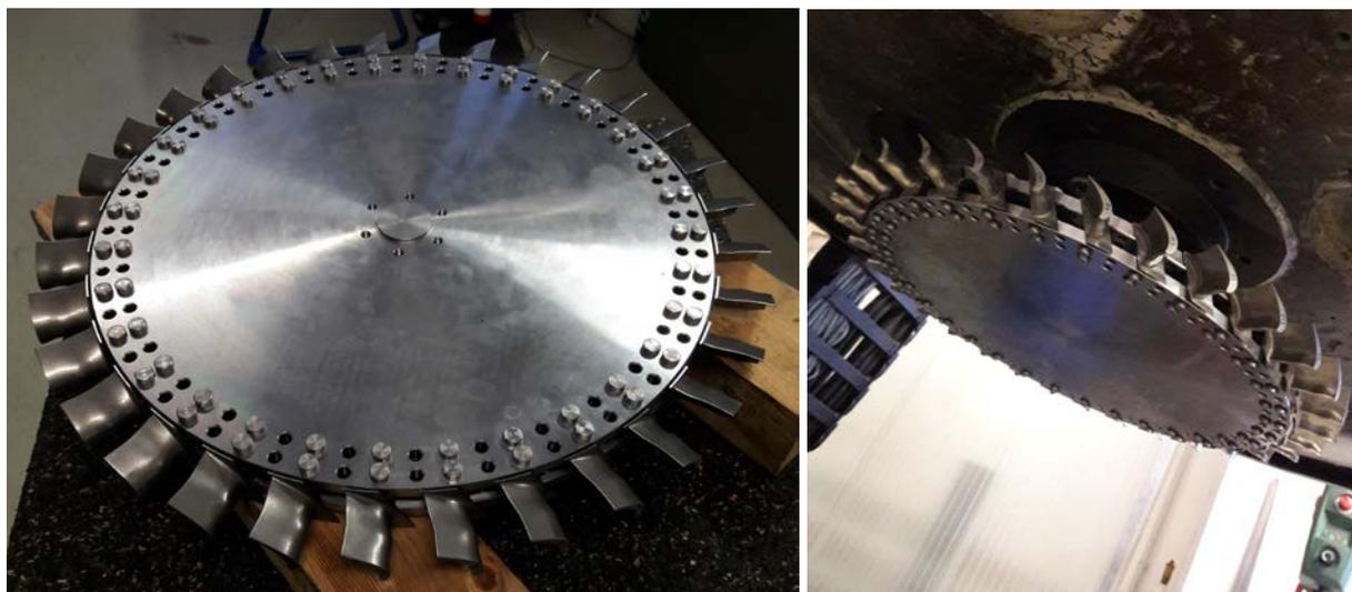
Abbildung 41: links: Schleuderscheibe bestückt mit optimierten TiAl-Schaufeln, rechts: eingebaut in den Schleuderprüfstand
