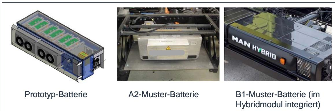
**Bild 2.1.1-2:** Im Prototypfahrzeug verwendete HV-Batterie-Musterstände
