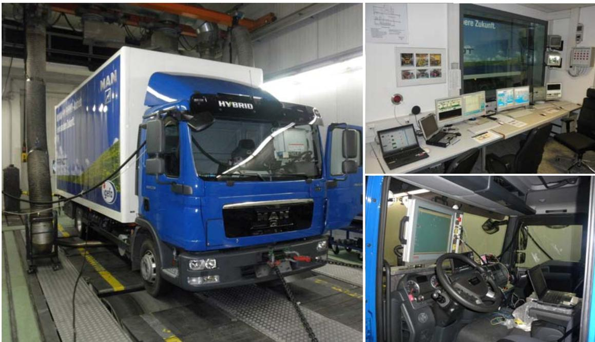
**Bild 2.2.3-1:** Rollenprüfstandmessungen mit einem TGL-Hybrid-Erprobungsfahrzeug
