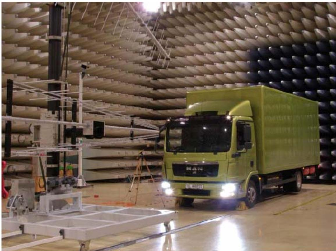
**Bild 2.2.2-1:** EMV-Störaussendung/-festigkeitsmessung in der EMV-Halle
