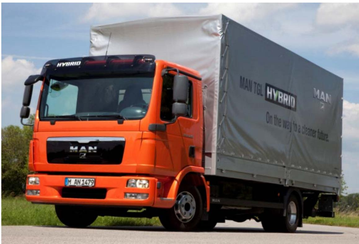
**Bild 2.1.3-7:** Foto des aufgebauten Plug-In-TGL-Hybrid-Prototypfahrzeugs
