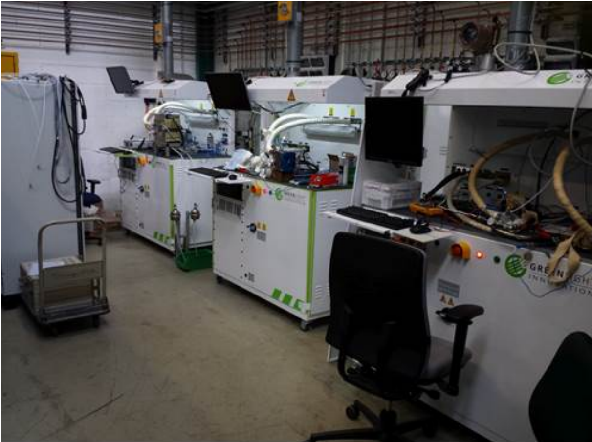
Abbildung 1: Neue 1,3 kW (Links) und 2,5 kW (Mitte) Teststände im neuen Testraum, rechts ein vorhandener 3 kW Teststand des gleichen Herstellers
