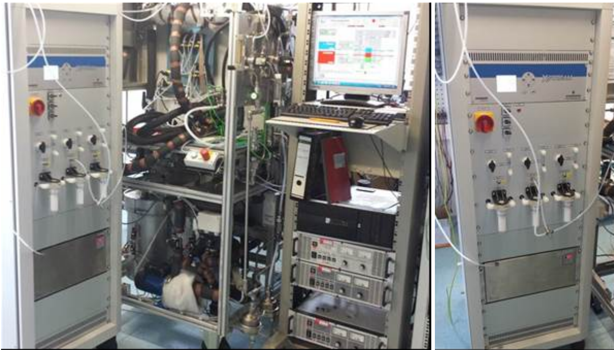
Abbildung 12: Portables CO 2 -Analysesystem an einem Teststand
