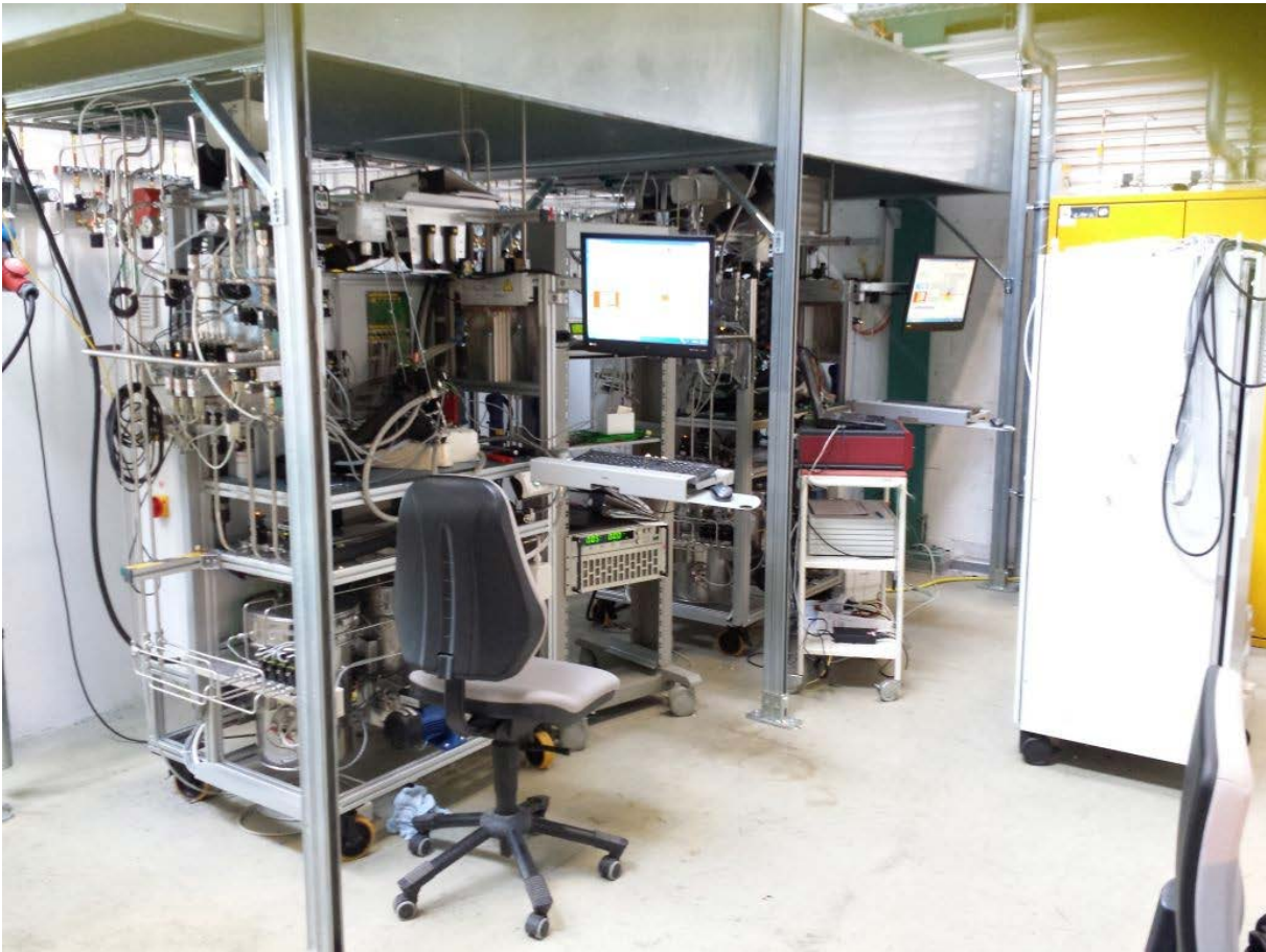
Abbildung 2: Selbstgebaute 3 kW Teststände unter ihrer Abzugshaube im neuen Testraum
