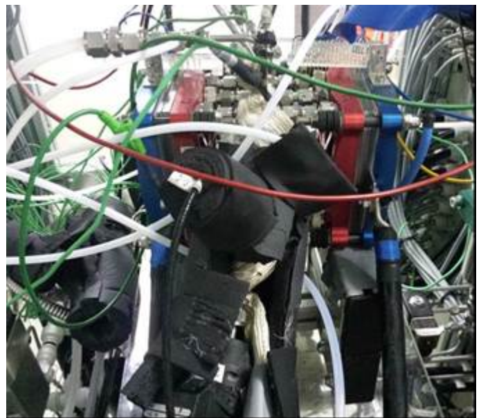
Abbildung 11: Paralleler Test von 2 Brennstoffzellenstapeln auf einem hochdynamischen Teststand,
