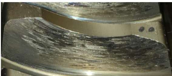
Abb. 35: Tragbild nach T_2=600\text{Nm}
