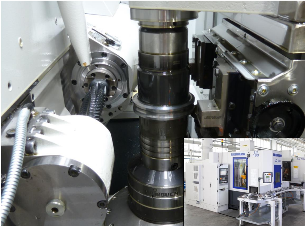
Abbildung 12: Wälzfräsen von Schneckenrädern (Phase 1)
