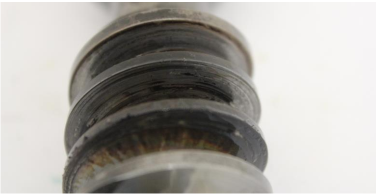
Abbildung 45: Schnecke 0029, Gratbildung und Wärmeeinfluss (Ölwechsel im Anschluss)
