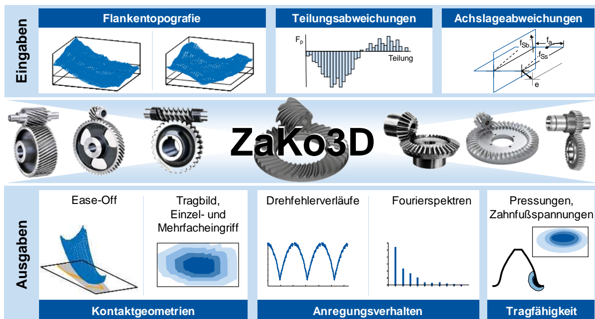
Bild 3–1: Leistungsumfang der FE-basierten Zahnkontaktanalyse ZaKo3D
