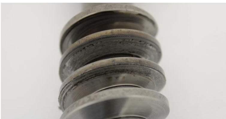
Abbildung 37: Schnecke 0025, Gratbildung Versuch 6, Schneckenrad 0067, Schnecke 0026 Versuch 6 stoppte nach Erreichen von 275 Nm.
