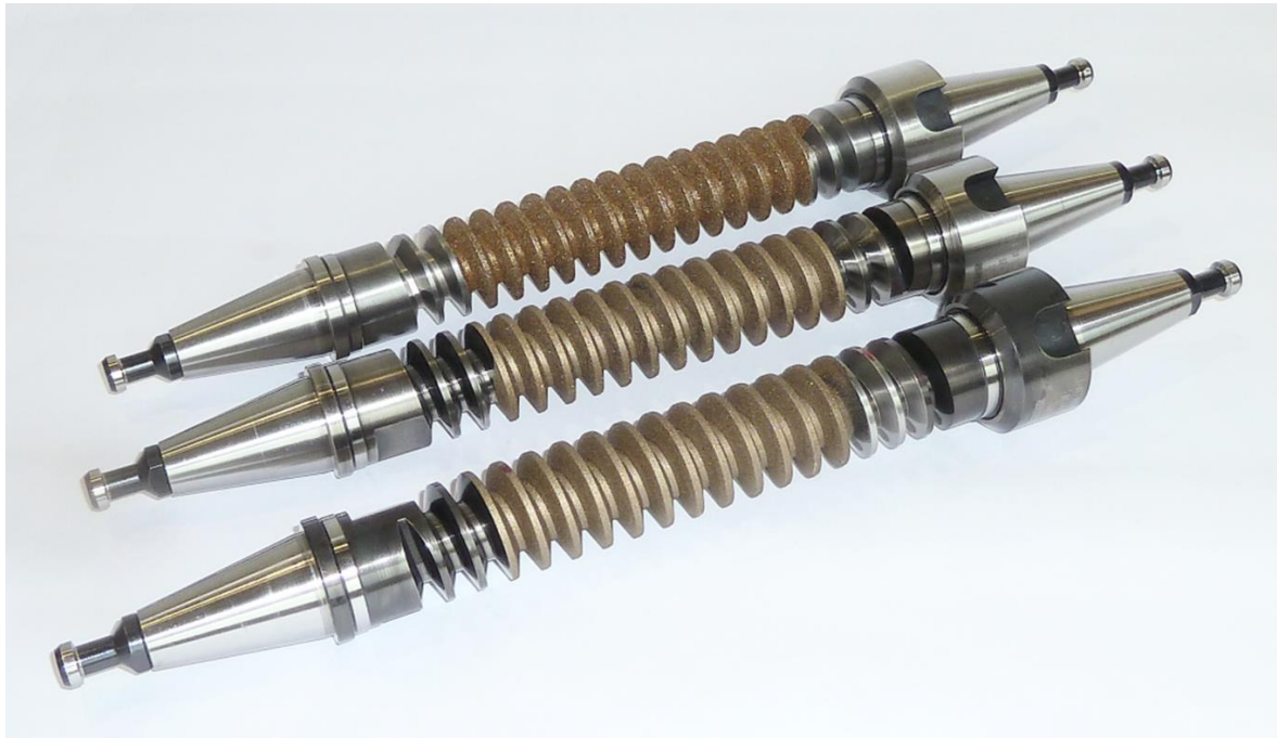
Abbildung 21: galvanisch belegte CBN-Schleifschnecken (Schruppen & Schlichten)
