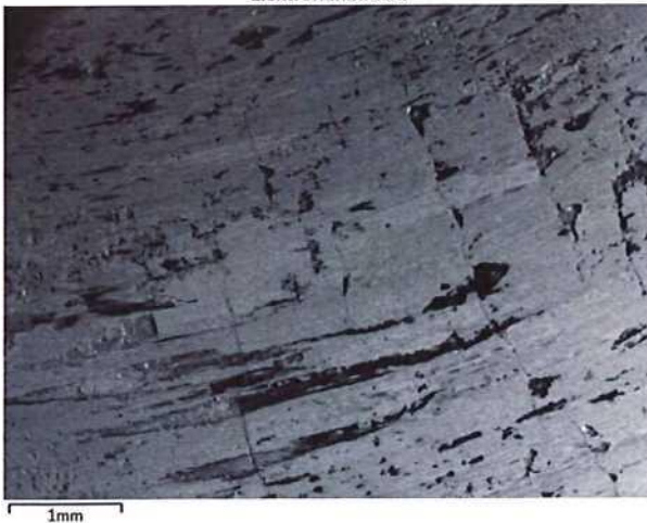
Bild 2: Rasterelektronenmikroskopische Aufnahme des Schnekenzahn 0820V nach dem Testlauf
