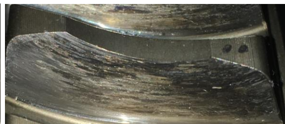
Abb. 36: Tragbild nach T_2=700\text{Nm}
