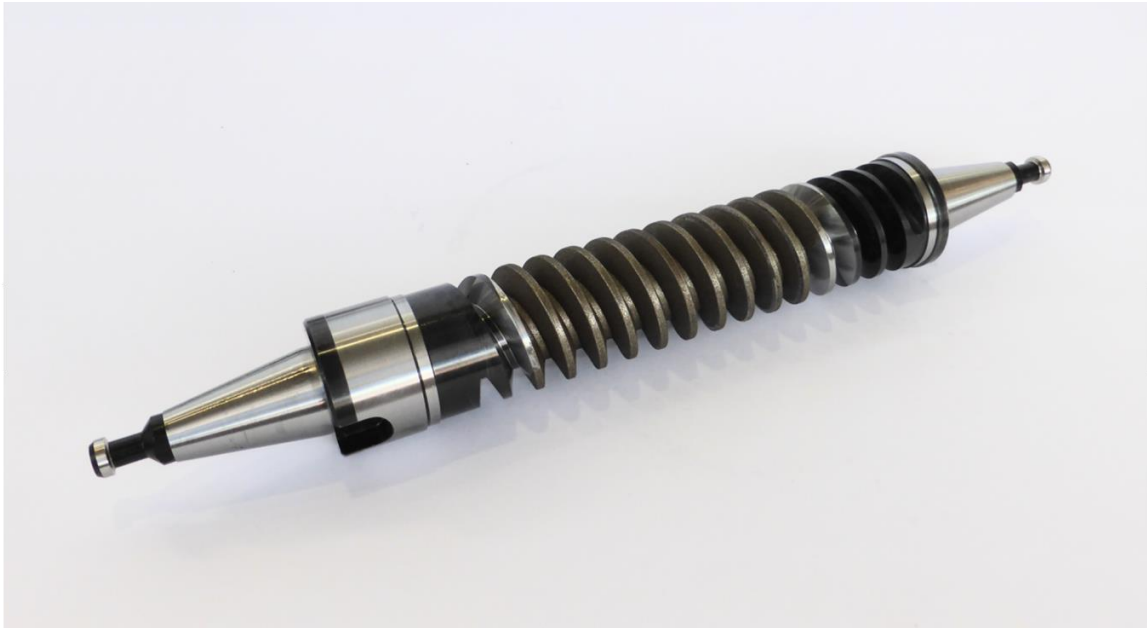
Abbildung 32: galvanisch belegte CBN-Schleifschnecken (m4, Schlichtschnecke)
