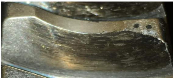
Abb. 31: Tragbild nach T_2=700\text{Nm}
