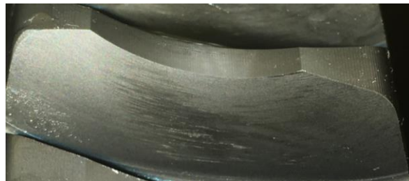
Abb. 25: Tragbild nach T_2=890\text{Nm}
