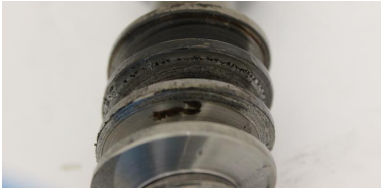
Abbildung 35: Schnecke 0024, Gratbildung Versuch 5, Schneckenrad 0068, Schnecke 0025 Versuch 5 stoppte nach Erreichen von 375 Nm.
