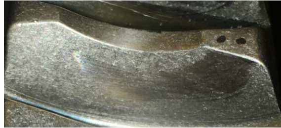
Abb. 30: Tragbild nach T_2=600\text{Nm}
