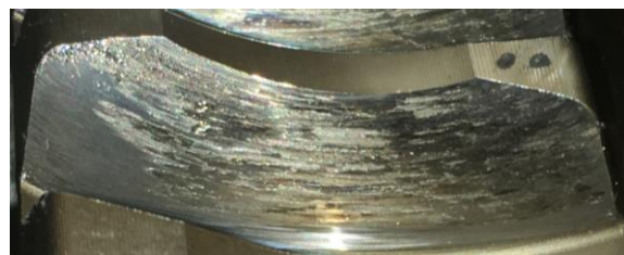
Abb. 34: Tragbild nach T_2=500\text{Nm}
