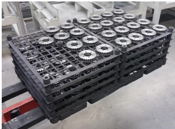
Abbildung 10: Exemplarische Darstellung einer Wärmebehandlungscharge für Schneckenräder auf CFC-Chargiermaterial zur Verzugsminimierung.
