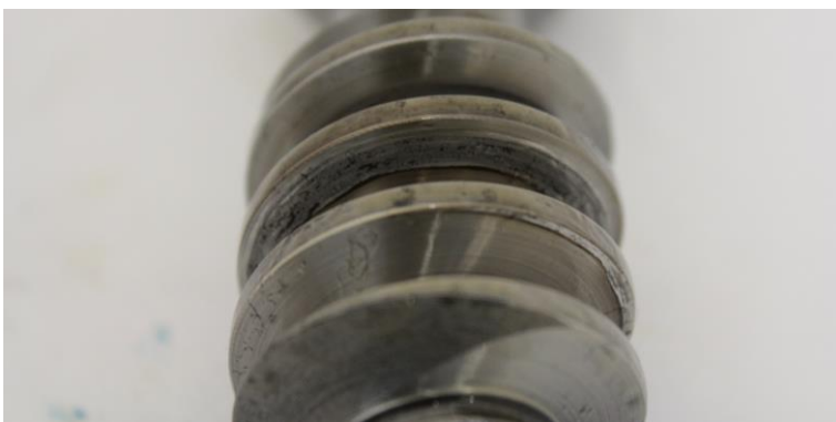
Abbildung 43: Schnecke 0028 Versuch 9, Schneckenrad 0057, Schnecke 0029 Versuch 9 stoppte nach Erreichen von 295 Nm.
