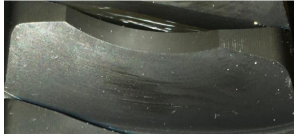
Abb. 23: Tragbild nach T_2=610\text{Nm}
