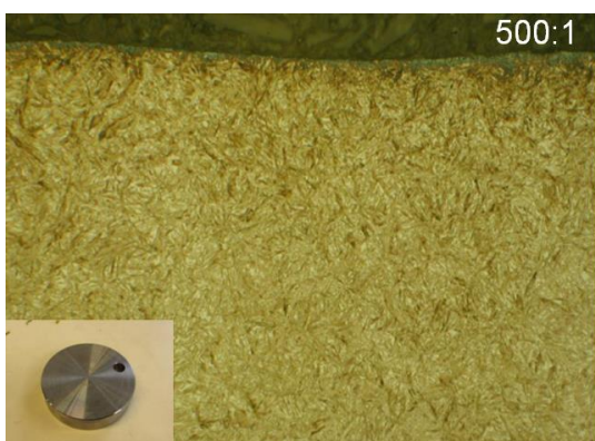
Abbildung 5: Gefüge und Härteverlaufsspur einer C-Scheibe aus 18CrNiMo7-6, für den Ansatz des definierten Härteunterschieds.
