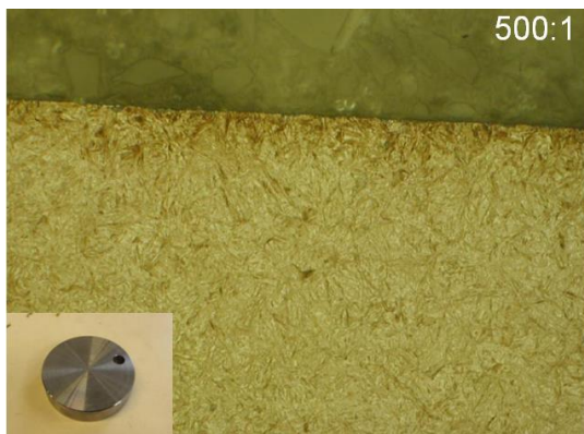
Abbildung 4: Gefüge und Härteverlaufsspur einer C-Scheibe aus 16MnCr5, für den Ansatz des definierten Härteunterschieds.
