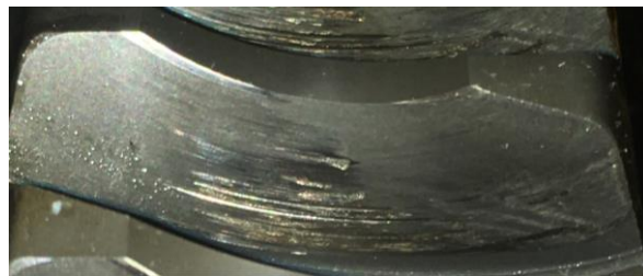
Abb. 27: Tragbild nach T_2=1170\text{Nm}
