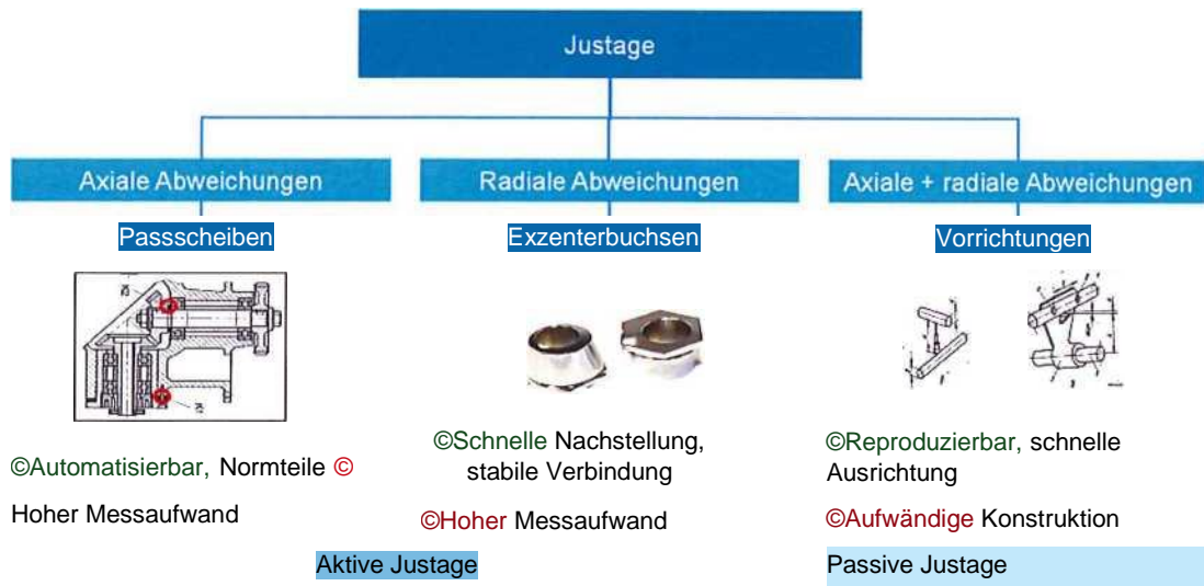
Abbildung 11: Übersicht der Justagemöglichkeiten eines Schneckengetriebes
