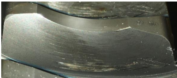
Abb. 26: Tragbild nach T_2=1030\text{Nm}
