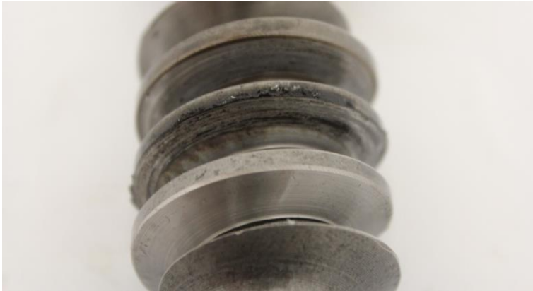
Abbildung 41: Schnecke 0027, Gratbildung Versuch 8, Schneckenrad 0061, Schnecke 0028 Versuch 8 stoppte nach Erreichen von 315 Nm.
