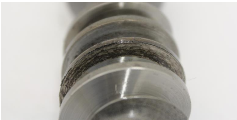
Abbildung 39: Schnecke 0026, Gratbildung Versuch 7, Schneckenrad 0066, Schnecke 0027 Versuch 7 stoppte nach Erreichen von 295 Nm.
