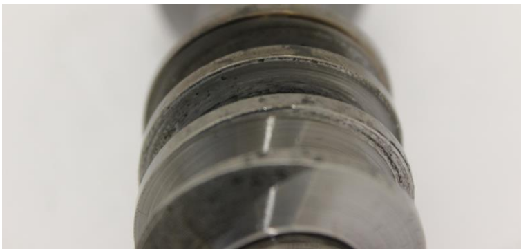
Abbildung 33: Schnecke 0023, Gratbildung Versuch 4, Schneckenrad 0069, Schnecke 0024 Versuch 4 stoppte nach Erreichen von 415 Nm.
