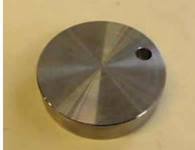
Abbildung 2 Probescheibe/C-Scheibe für die Rezeptentwicklung oder Prozessüberwachung von Wärmebehandlungsprozessen.
