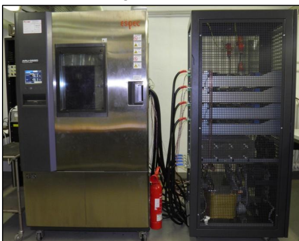
Abbildung 25: Prüfstand bestehend aus der Temperaturkammer (links) und dem Zykliegerät (rechts). Die Temperaturkammer kann Temperaturen von -40-+185°C abbilden, das Zykliegerät kann auf vier Kanälen bis zu je 200 A bereitstellen.
