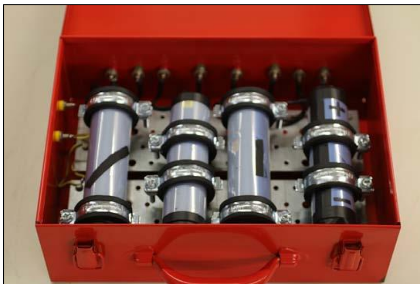
Abbildung 26: Vier 15-Ah-Zellen in LFP-Technologie eingebaut in einer Metallbox für die Prüfstandsuntersuchung
