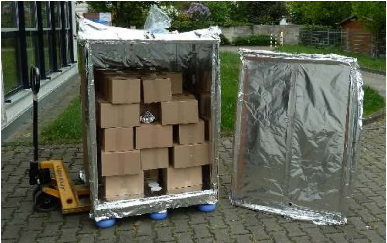
Abbildung 14: Mit Aluminiumfolie ausgekleidete, geöffnete Testkiste nach Ablauf der Versuchsdauer von 44 Tagen (Szenario 4). Auf dem Boden sind die Passivsammler (Papierfilter) zu erkennen. Bei dem silbernen Päckchen zwischen den Kartons handelt es sich um einen zum Schutz vor Kontaminationen verpackten Temperaturlogger.
