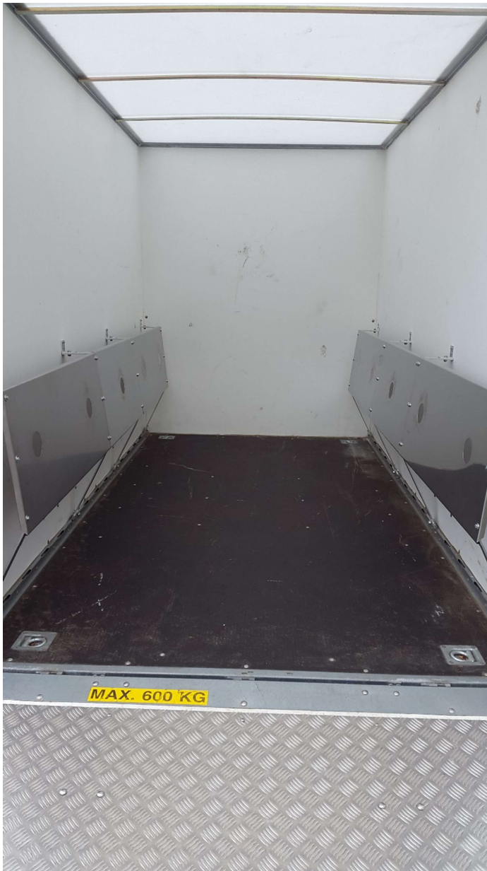
Abbildung 12: Differenzierungstrecke für Spürhunde. In links und rechts angebrachten Edelstahlpanelen befinden sich jeweils 4 Aussparungen für Geruchsdosen aus Metall zur Aufnahme der Filterproben.
