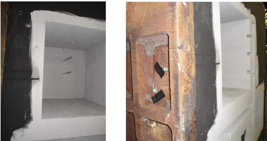
Abbildung 2.7: Sandform nach der Instrumentierung – die Lage der Thermoelemente Typ K
