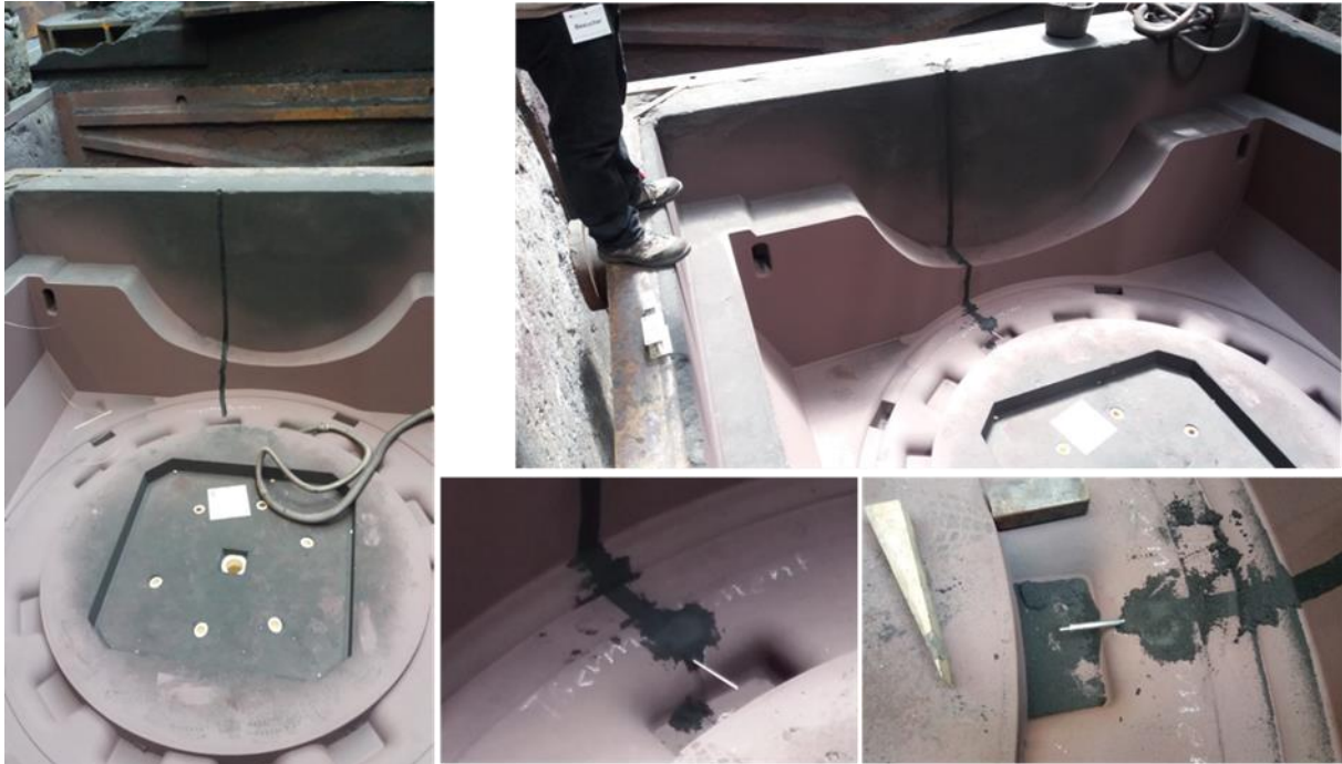
Abbildung 2.10: In die untere Formhälfte eingebautes Thermoelement 5
