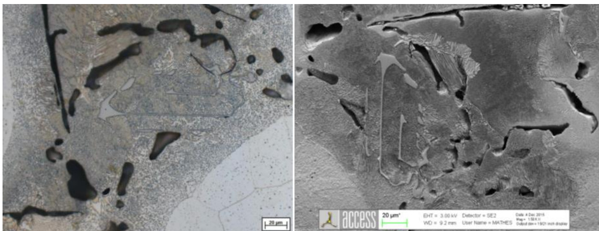
Abbildung 2.20: Gefügebilder einer Probe aus dem Zentrum des Blockes 5, Abguss 1; geätzt, 500x (links), tief geätzt, 500x (rechts)
