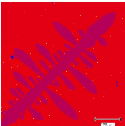
Abbildung 1.4: Keimbildung von Graphit (dunkelblau) auf MnS-Precursor-Partikeln [30]
