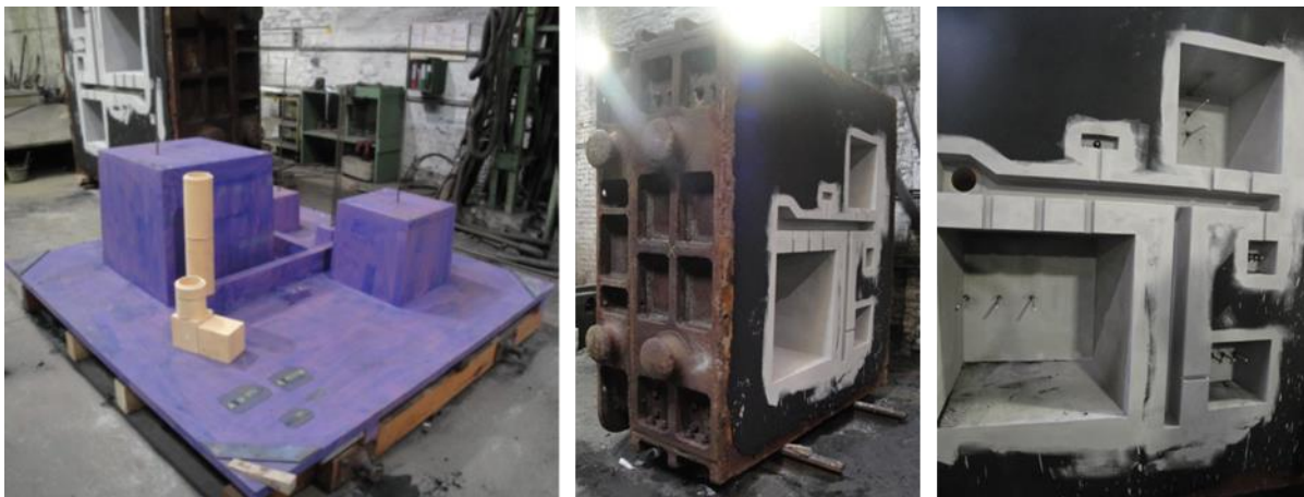
Abbildung 2.5: Die Modellplatte (links) und die Sandform vor (mitte) und nach der Instrumentierung (rechts)
