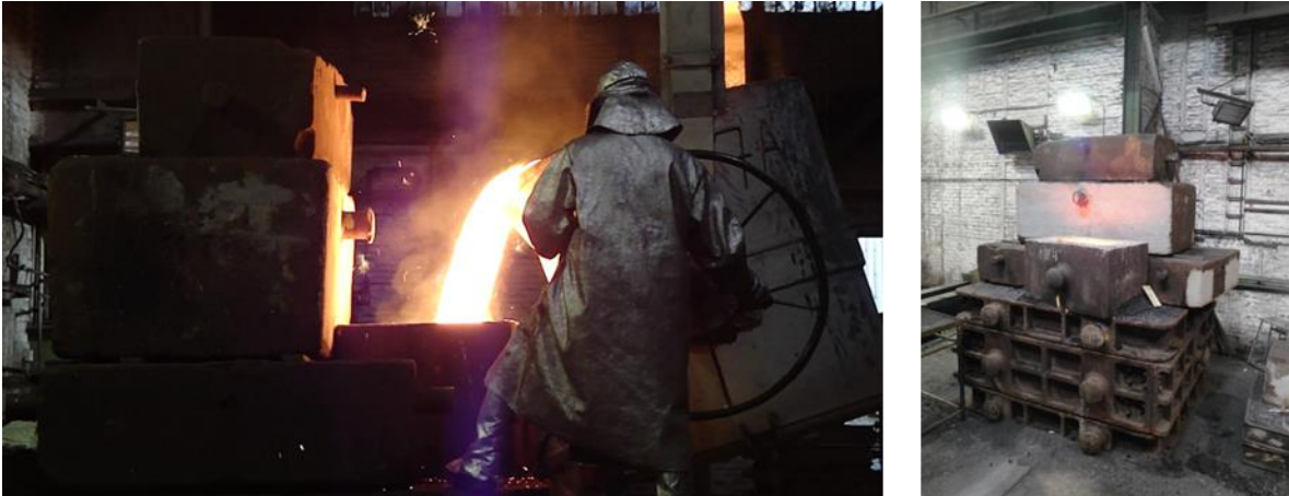
Abbildung 2.6: Abguss (links); Abkühlung der Schmelze in der Form nach dem Abguss (rechts)
