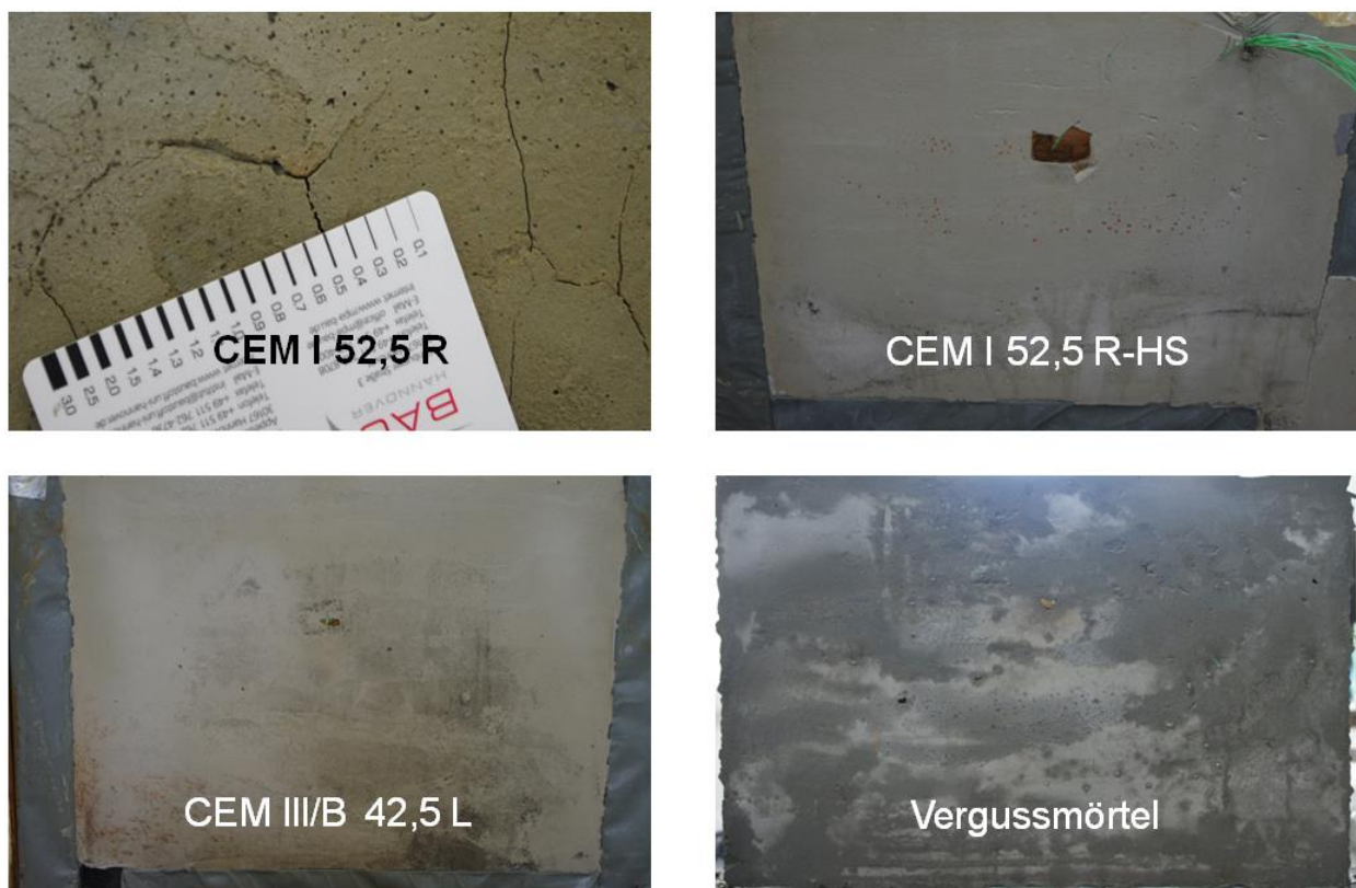
Abbildung II-107: Aus dem Unterwasserversuchsstand entnommene Probekörper
