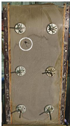
(a) Lufteinschluss (weiße Elipse) (b) Fehlstelle nach dem Ausschalen
