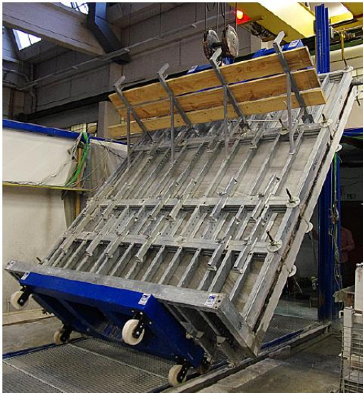
(a) Kippen der Versuchsschalung
