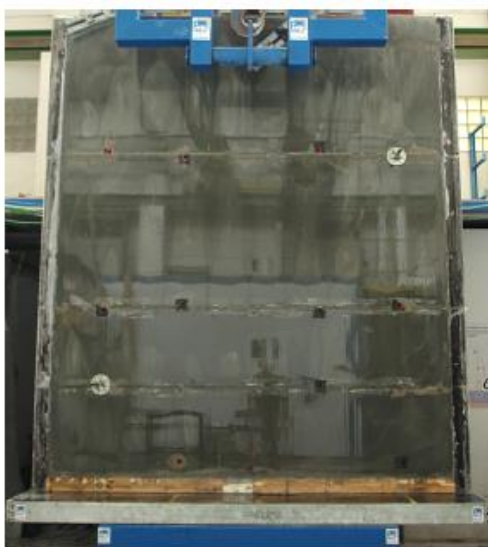
Abbildung II-88: Ausgeschaltetes Bauteil (links) und relative Druckfestigkeitsverteilung (rechts), Material B (Werner, 2017)
