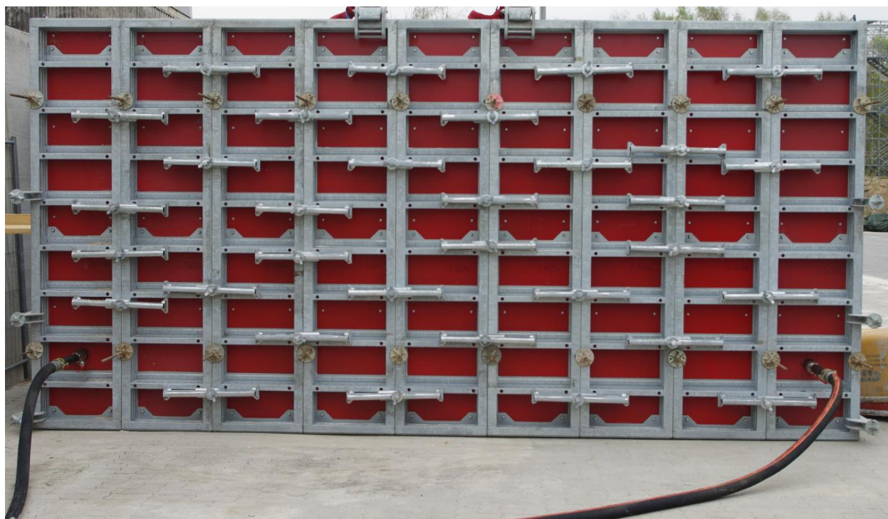
Abbildung II-108: Foto des Fließversuchsstandes mit den bereits angeschlossenen Förderschläuchen an den Einfüllstutzen
