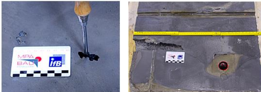
(a) Lufteneinschlüsse auf der Vordersei- (b) Teil einer Luftblase auf der Rückseite te
